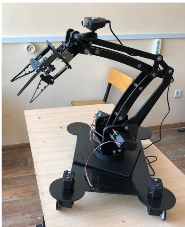
2.7 – сурет – Арбадағы жиналған робот-манипулятор
