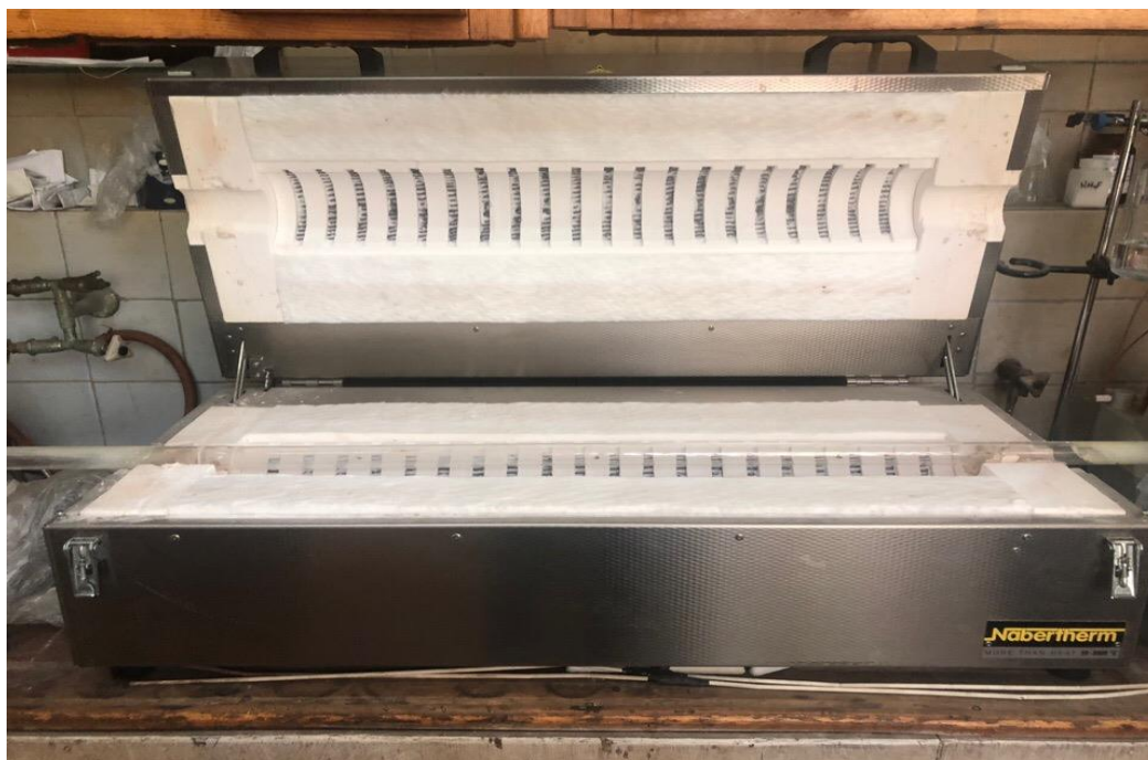
Рисунок 17– Трубчатая печь NABERTHERM с неподвижным слоем
