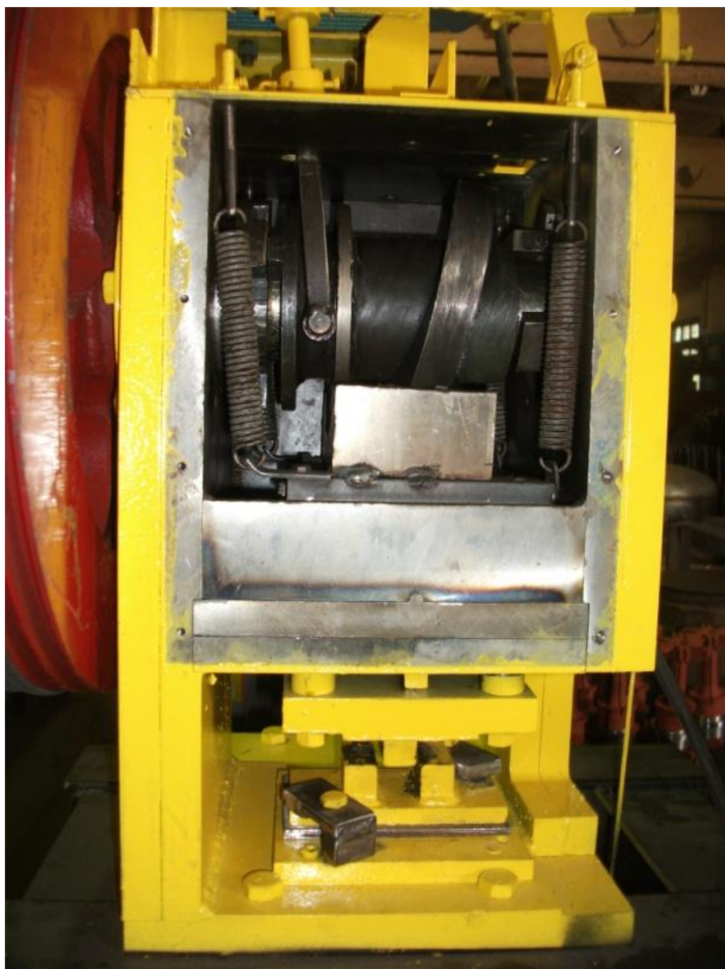
Рисунок 3.8 – Фото пресса, рабочая часть с инструментом
