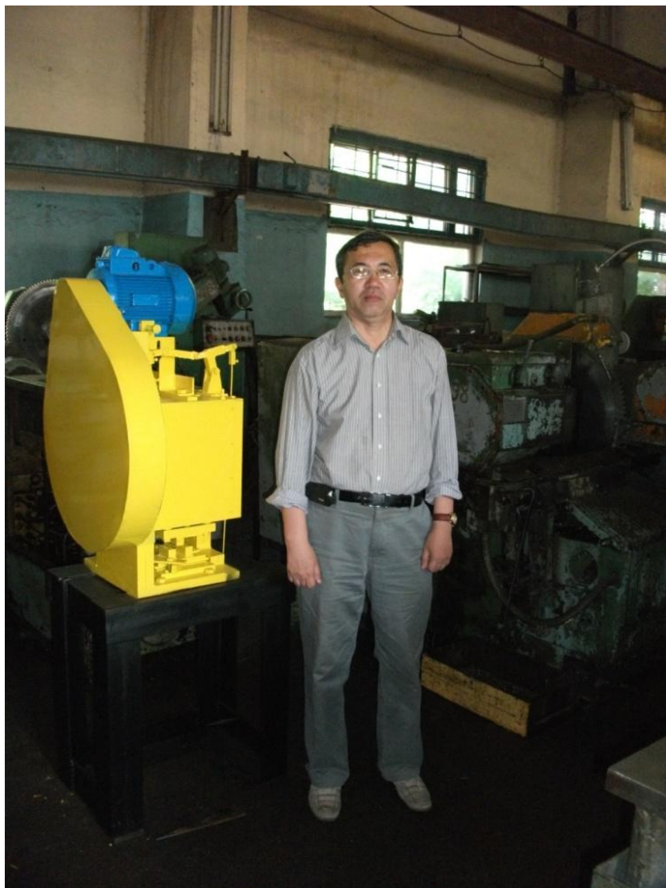
Рисунок 3.12 – Фото пресса в рабочем положении с установкой всех закрывающих кожухов
