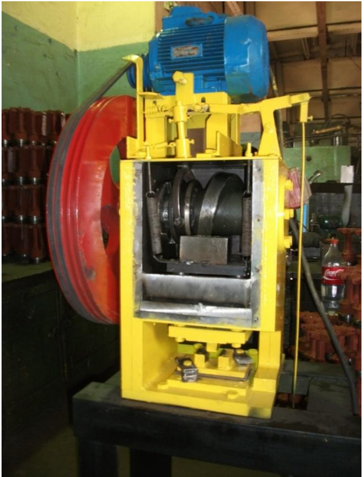
Рисунок 3.7 – Фото прессы после доводки и обкатки
