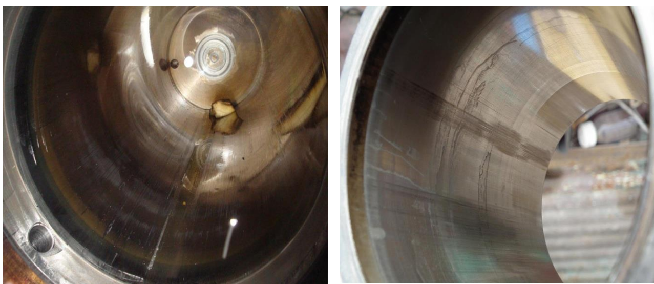
Рисунок 1.5 – Износ внутренней поверхности гильзы гидравлического цилиндра
