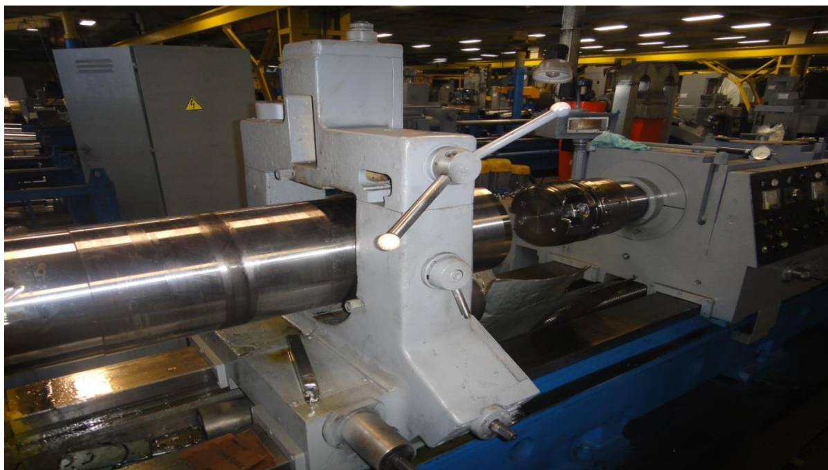
Рисунок 4.15 – Обработка образцов на станке РТ293131Ф1
