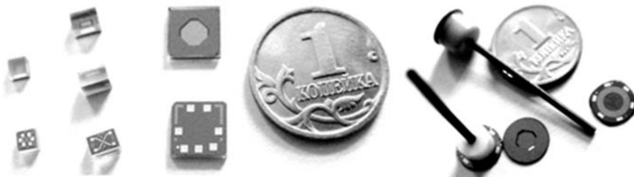
Рисунок 4.5 - Фотография микромеханических узлов (ЧЭ и ИМ) МЭД, изготовленных с применением ЭСС
