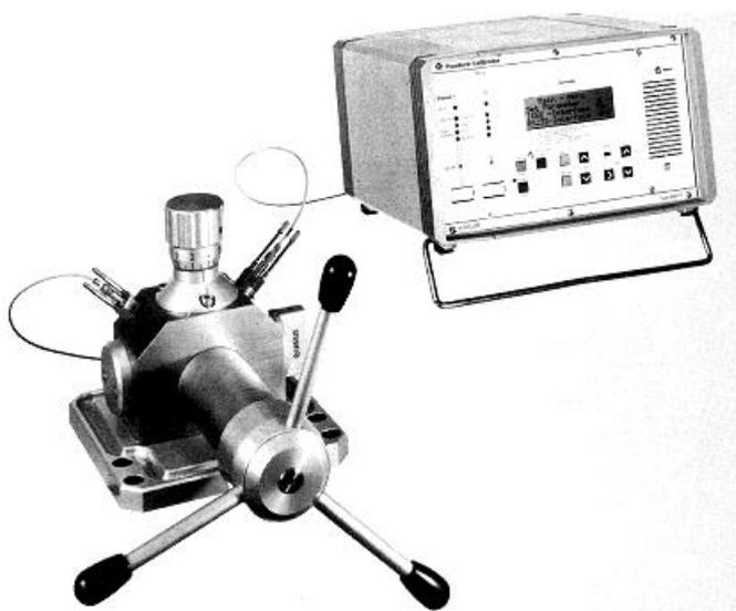
Рисунок 4.19 - Система калибровки пьезодатчиков фирмы «Kistler»
