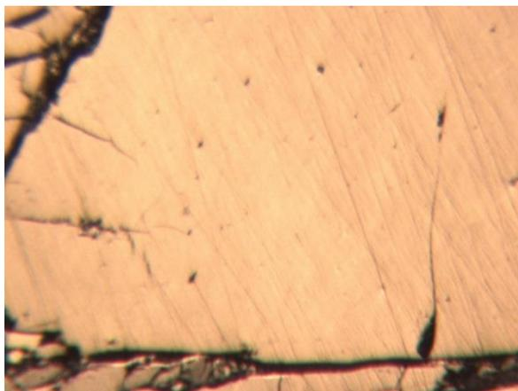
Рисунок 3.3 – Витринит под микрофотомером Leitz 307-107.002
