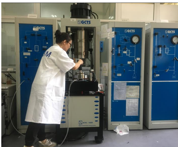
Рисунок 3.1 – Определение физико-механических свойств пород на машине системы тестирования GCTS: Rapid Triaxial Rock Testing System (RTR-1000). На фото автор проводит исследования
