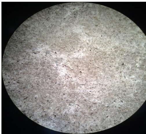
Рисунок 4.5 – Алевролиты (фотографии в параллельных и скрещенных николях) (Межкафедральная лаборатория ИГМЛ КазНУ)
