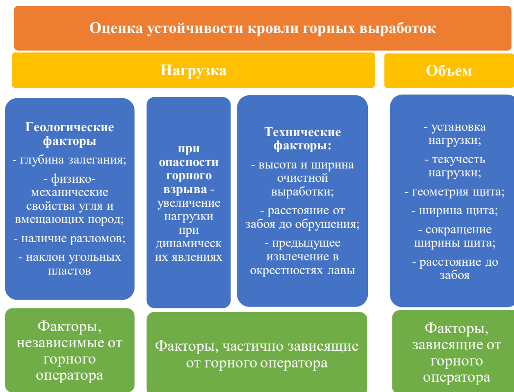
Рисунок 1.3 – Факторы, влияющие на устойчивость кровли горных выработок
