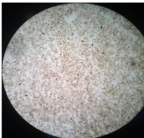
Рисунок 4.6 – Аргиллиты (фотографии в параллельных и скрещенных николях) (Межкафедральная лаборатория ИГМЛ КазНУ)
