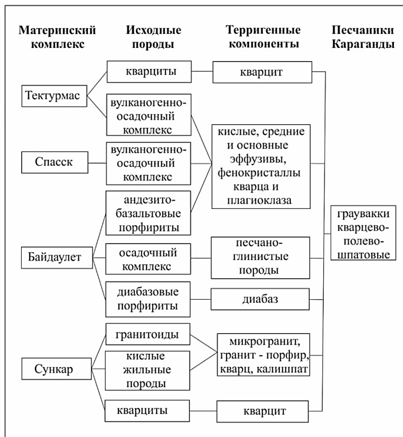
Рисунок 4.3 - Диаграмма формирования терригенных пород угленосной толщи Карагандинского бассейна из источников питающих провинций (Байбатша А., Сатибекова С., 2018)
