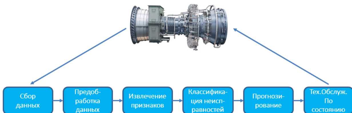
Рисунок 5.1 – Цикл ТОПС для газотурбинного двигателя
