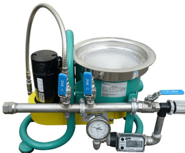
Рисунок 9 – Центробежный сепаратор Knelson
