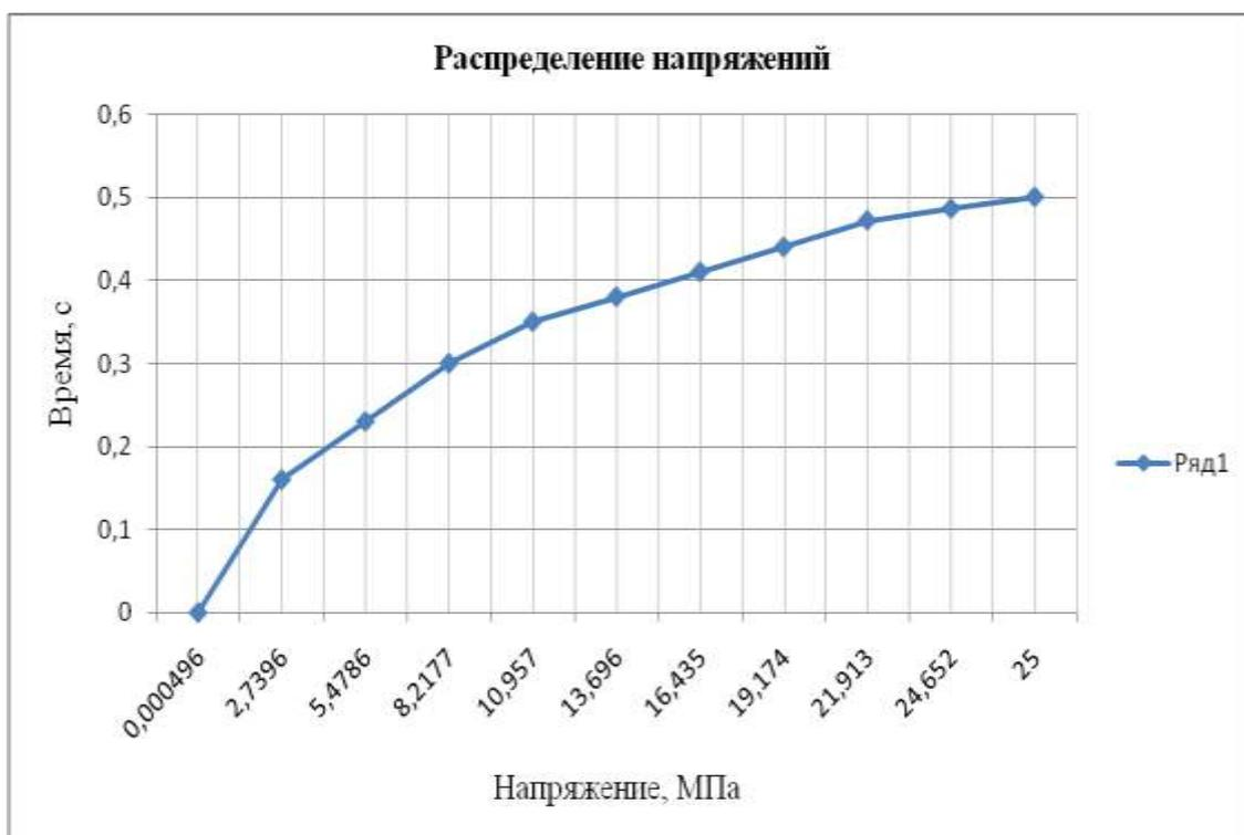
Рисунок 4.24 – Распределение напряжений при минимальном значении напряжения вала
