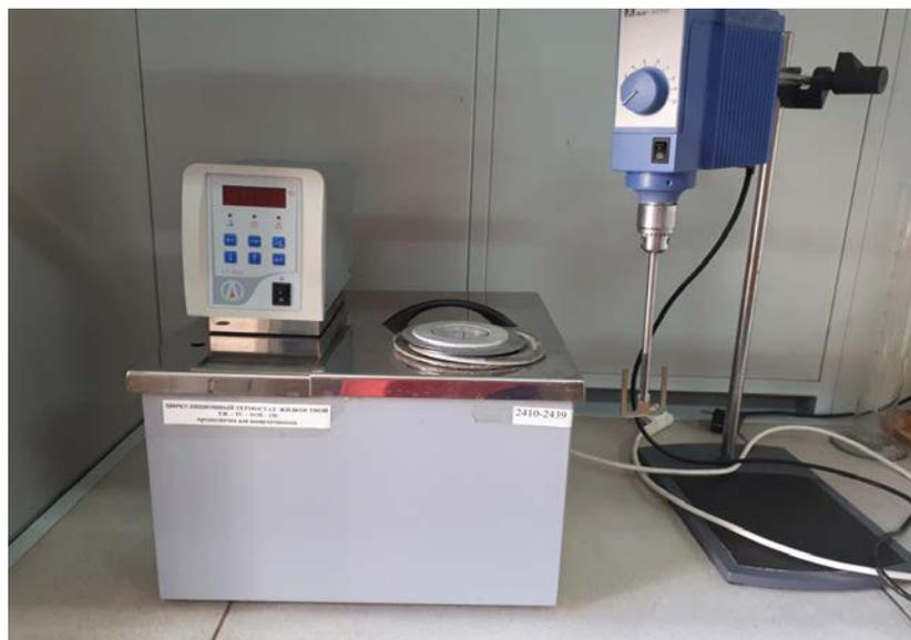
Рисунок 16 – Циркуляционный жидкостной термостат ТЖ – ТС – 01М – 150 для выщелачивания
