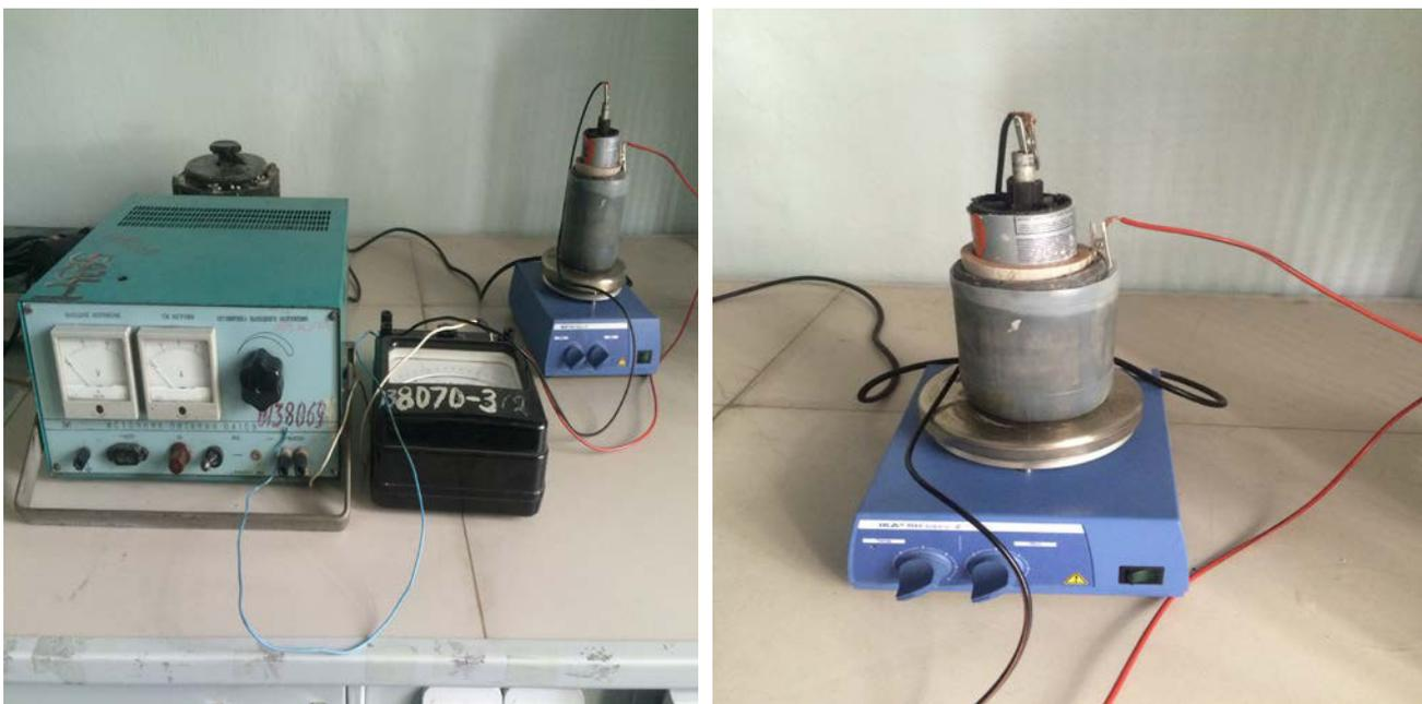
Рисунок 40 – Электролизер для электрохимического окисления ванадийсодержащих руд
