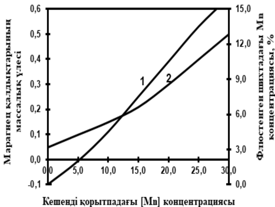
4.9 сурет – Кешенді қорытпадағы берілген марганец концентрациясын флюсті шихтадағы марганец қалдықтары мен марганец мөлшерінің массалық үлесіне тәуелділігі
