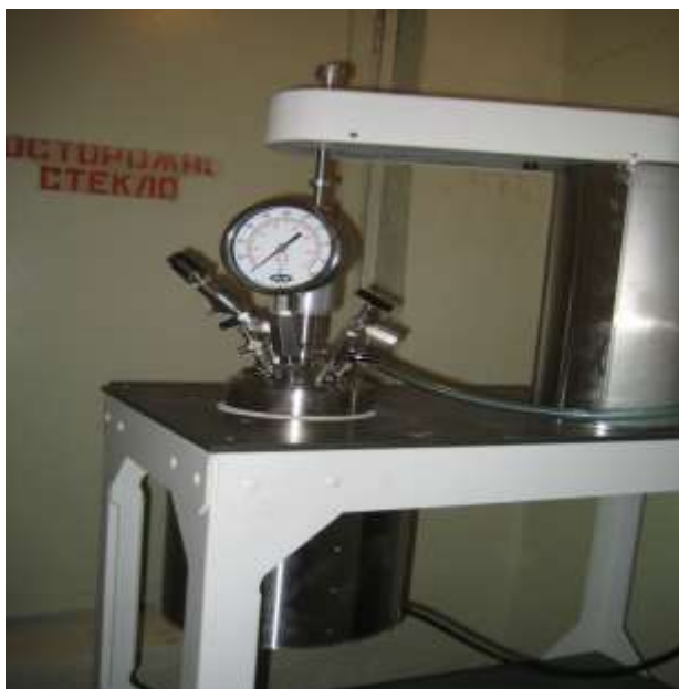
Рисунок 7 - Лабораторный автоклав и система управления
