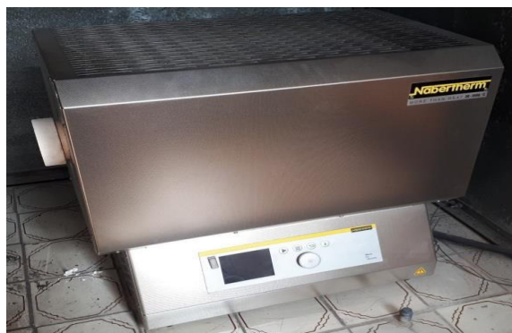
Сурет 7 – «RHTC 80 – 230/15 Controller B410» құбырлы электр пеші
