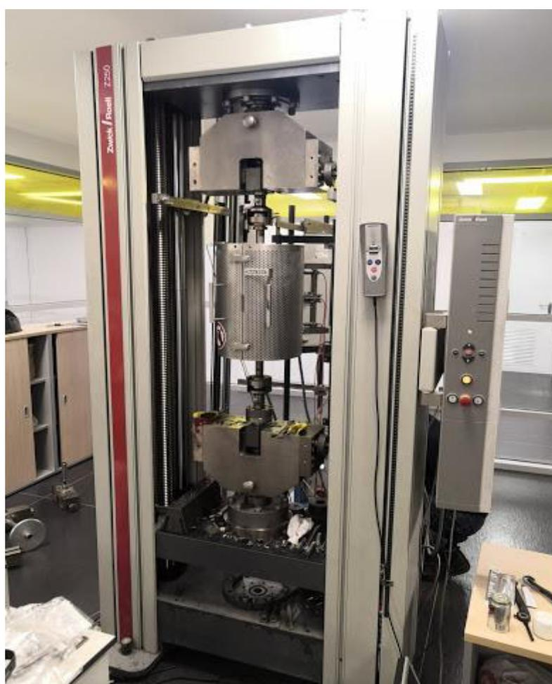
Рисунок 12 – Универсальная электромеханическая испытательная машина Zwick Z250
