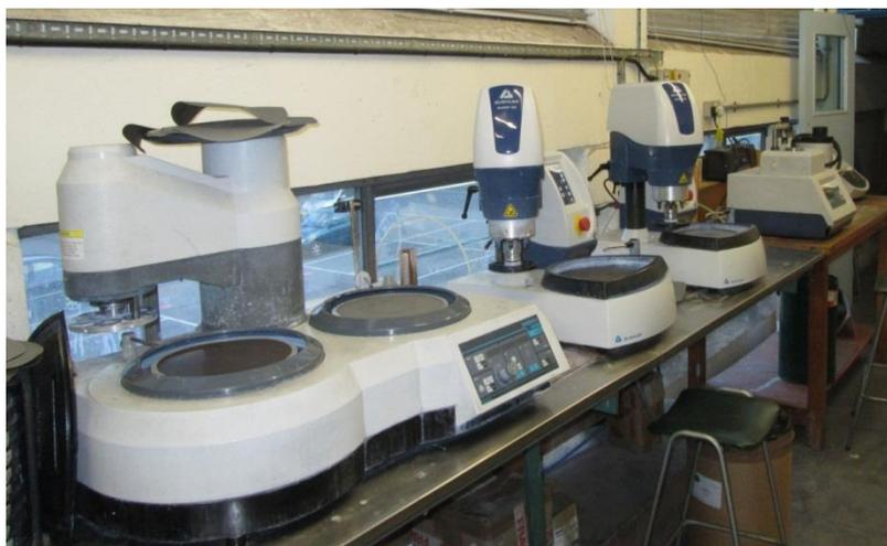
Рисунок 9 – Шлифовально-полировальные станки BUEHLER Phoenix
