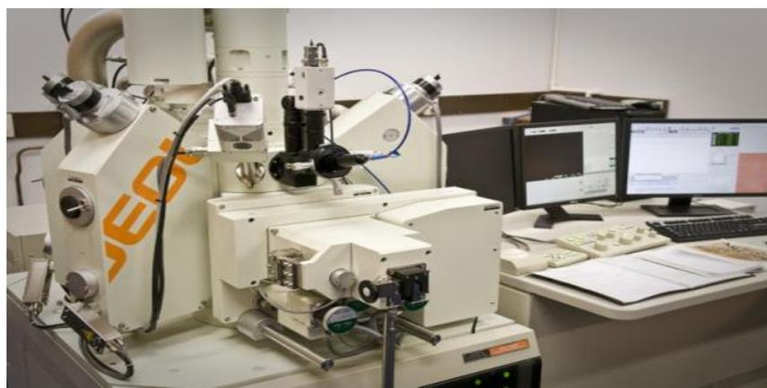
Рисунок 11 – Электронный растровый сканирующий микроскоп JEOLJXA-8230
