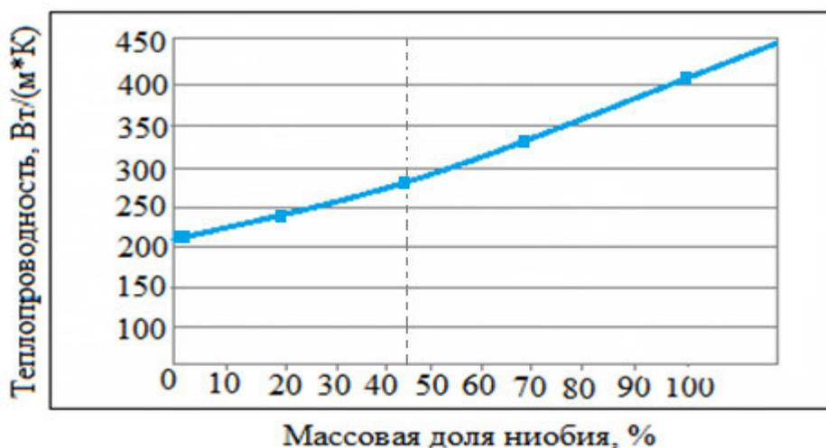
Рисунок 33 – Теплопроводность лигатуры Nb-Al на влияние массовой доли ниобия
