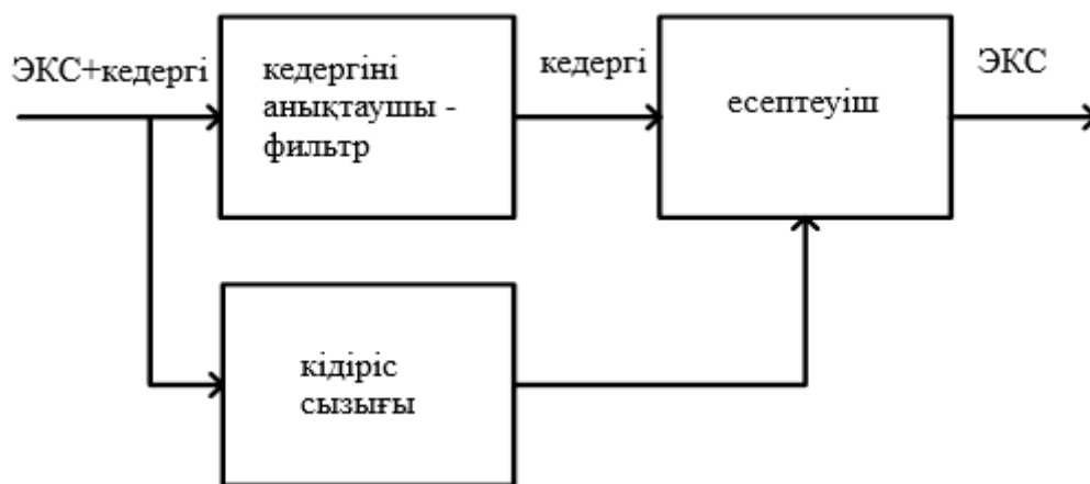
Сурет 19 – Кедергі компенсаторының құрылымы
