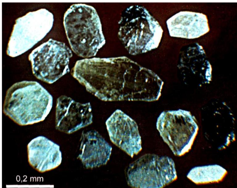
Рисунок 1.17 – Импактные алмазы, образовавшиеся при ударном сжатии графита, наследующие исходные формы шестиугольных графитовых пластинок [54]
