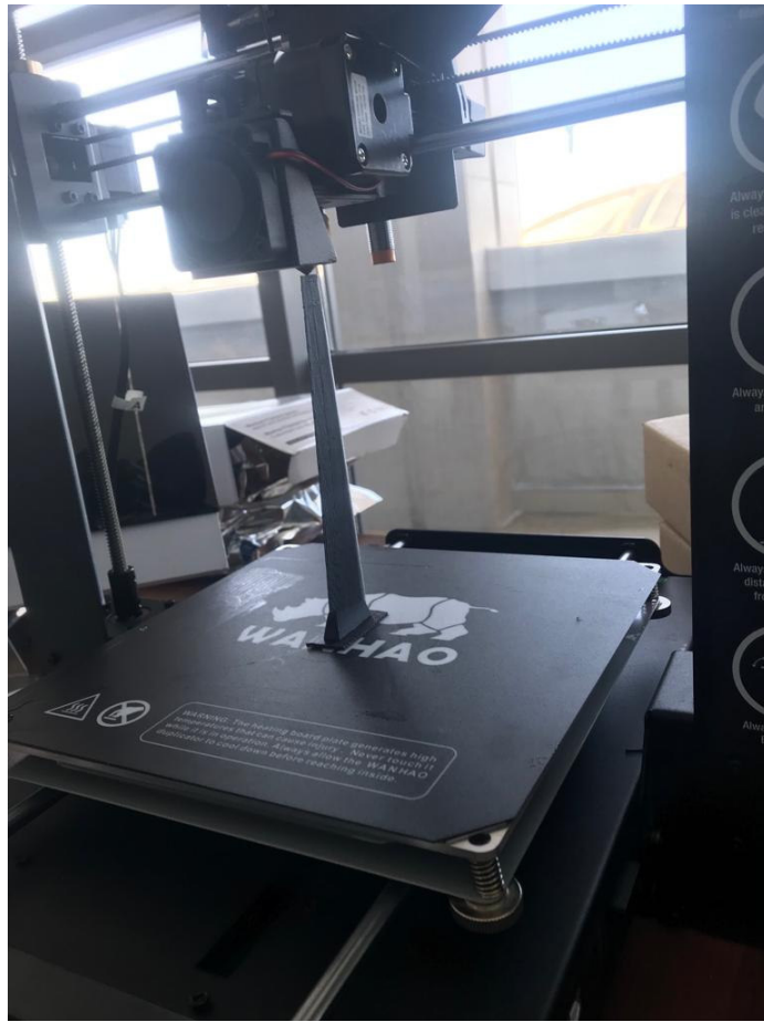
Рисунок 76 – Процесс изготовления лопасти ВЭУ при помощи 3D принтера
