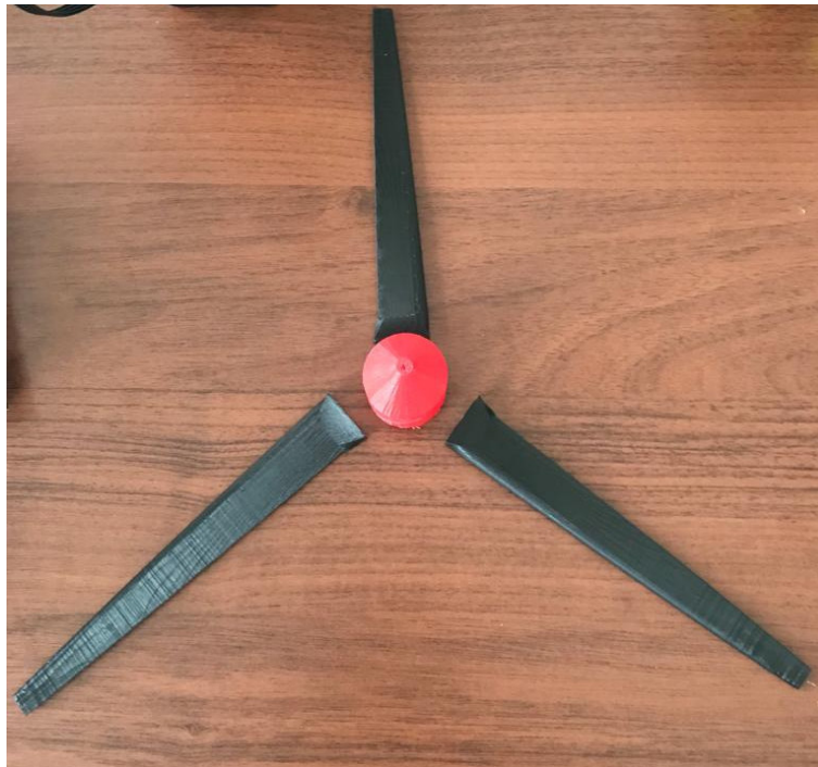
Рисунок 77 – Готовые детали ВЭУ, распечатанные в 3D принтере
