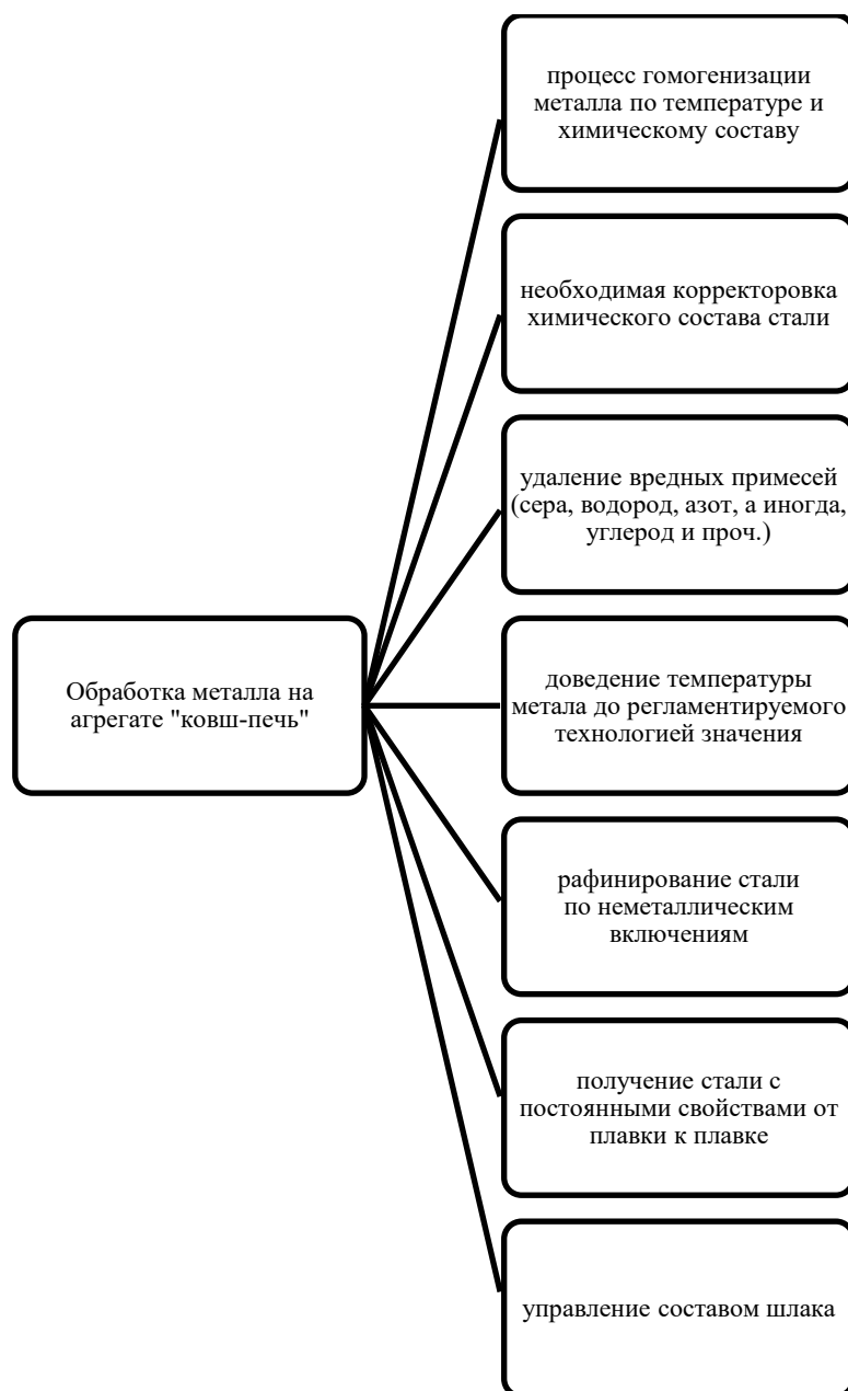
Рисунок 1.7 – Основные внепечные операции обработки стали на агрегате «ковш-печь»
