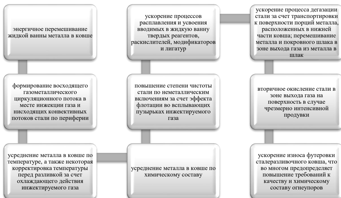
Рисунок 1.10 – Одновременные процессы, происходящие во время продувки стали в ковше
