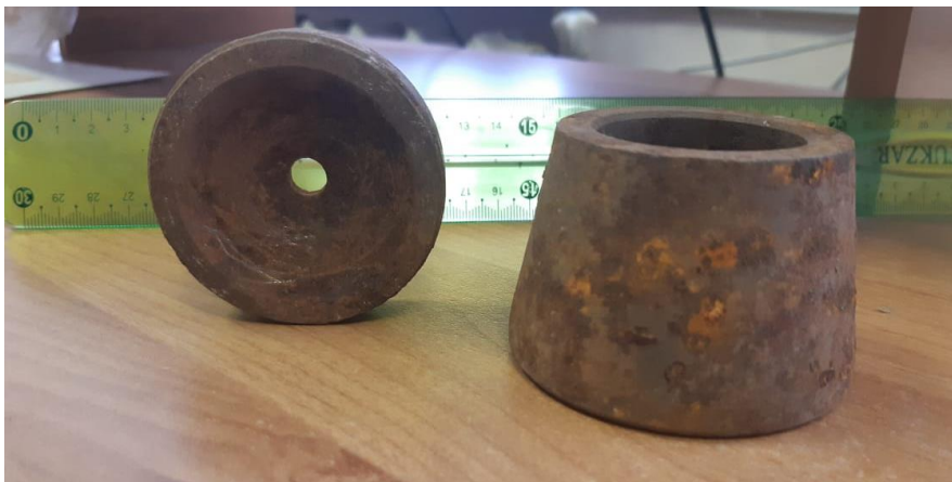
Рисунок 2.12. Конструкция лабораторной изложницы и прибыльной части к ней [50]
