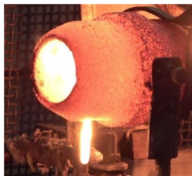
Рисунок 5.13 – Разливка металла с применением спиралевидного отсечного устройства
