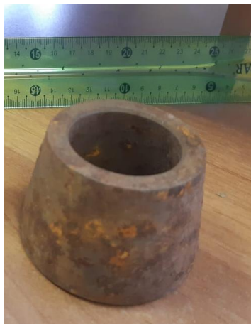
Рисунок 2.12. Конструкция лабораторной изложницы и прибыльной части к ней [50]
