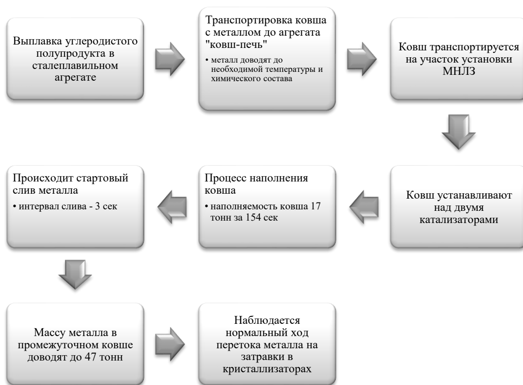
Рисунок 5.7 – Краткий алгоритм основных металлургических операций при работе предлагаемого устройства промежуточного ковша
