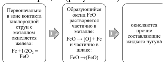
Рисунок 2.1 – Этапы окисления примесей при контакте с газообразным кислородом
