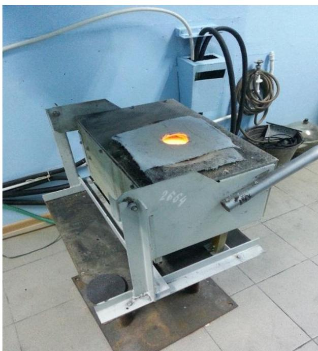
Рисунок 7 – Индукционная плавильная установка УИП-16-10-0,005
