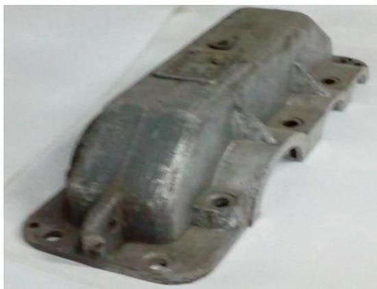
Рисунок 4.10 – Верхняя крышка корпуса редуктора
