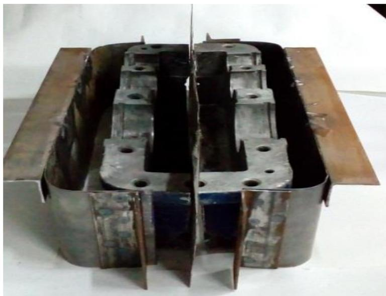
Рисунок 4.4 – Установка разделительной пластины в каркас основания редуктора
