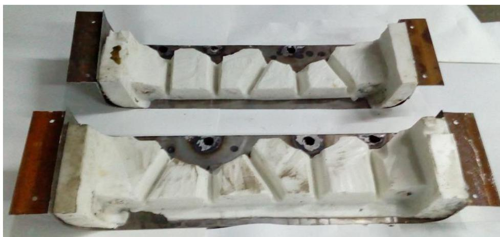
Рисунок 4.5 – Формы для литья основания редуктора
