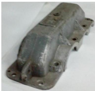
Рисунок 4.1 – Крышка корпуса редуктора
