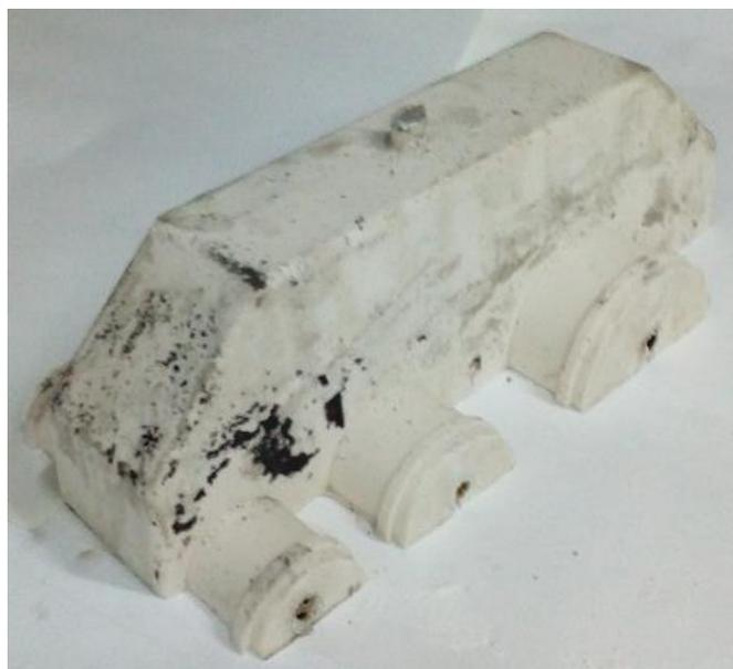
Рисунок 4.3 – Силиконовая модель внутренней полости корпуса редуктора
