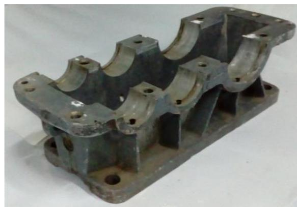
Рисунок 4.11 – Нижняя крышка корпуса редуктора
