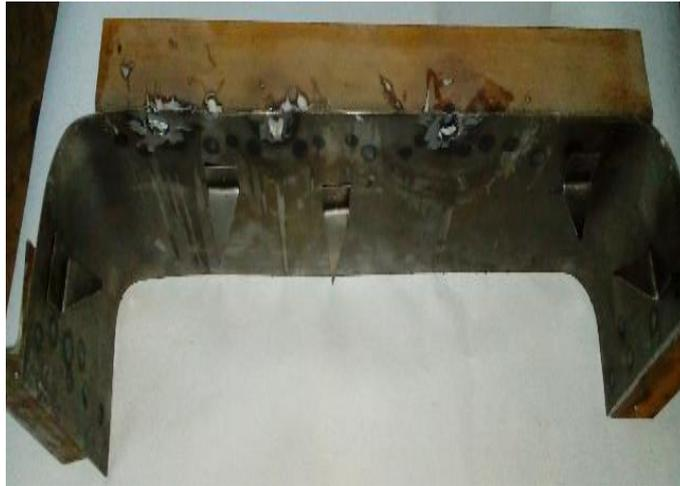
Рисунок 4.2 – Каркас формы крышки редуктора
