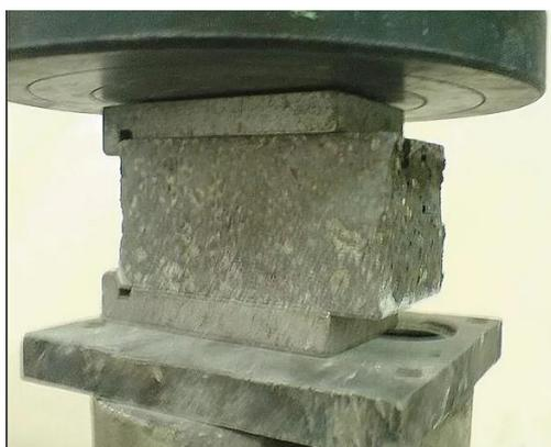
Рисунок 3.13 – Размещение нажимных пластинок и образцов на прессе
