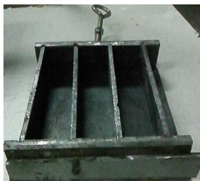
Рисунок 3.5 – Формы для изготовления контрольных образцов – призм квадратного сечения
