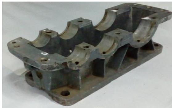
Рисунок 9 – Нижняя крышка корпуса редуктора
