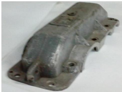
Рисунок 8 – Верхняя крышка корпуса редуктора
