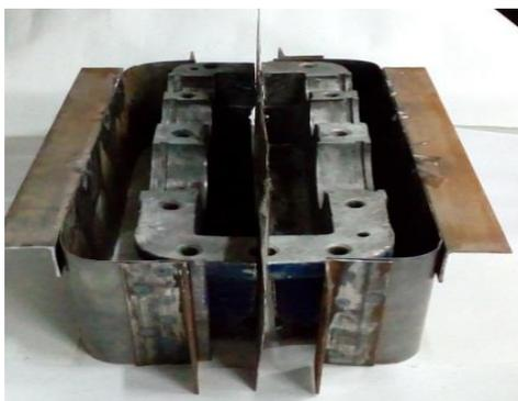
Рисунок 3 – Установка разделительной пластины в каркас основания редуктора
