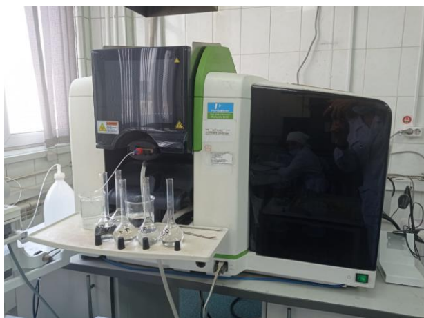
Рисунок 2.1 – Атомно-абсорбционный спектрометр PinAAcle, фирмы PerkinElmer
