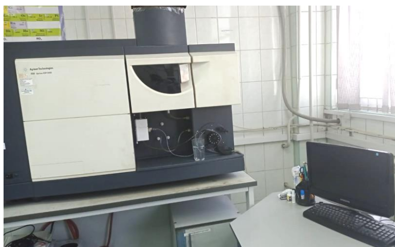
Рисунок 2.2 – Оптико-эмиссионный спектрометр с индуктивно-связанной плазмой Agilent 710 ES
