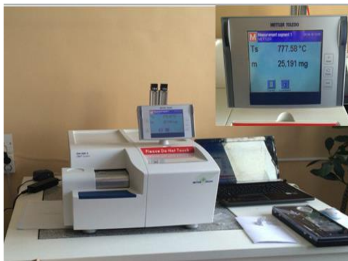
Рисунок 2.3 – Термогравиметрический анализатор фирмы «Mettler Toledo»
