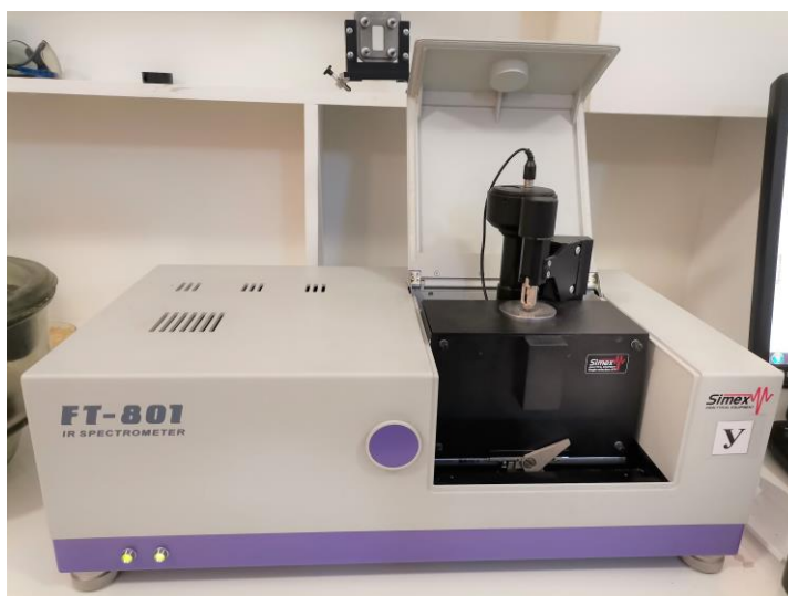
Рисунок 2.5 – ИК спектрометр FT-801 фирмы Simex
