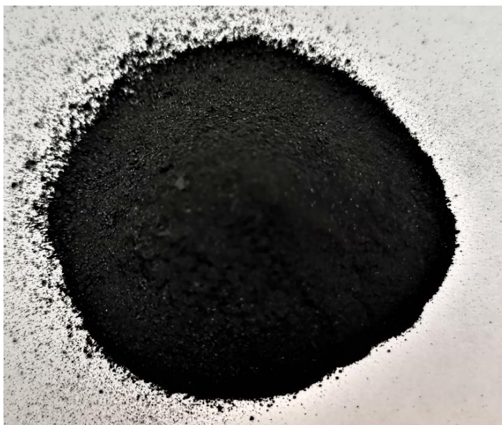
Рисунок 3.15 – Внешний вид свинцово-медного кека, полученного в процессе серощелочного выщелачивания
