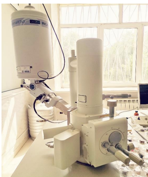
Рисунок 2.6 – Растровый электронный микроскоп JSM-6390LV
