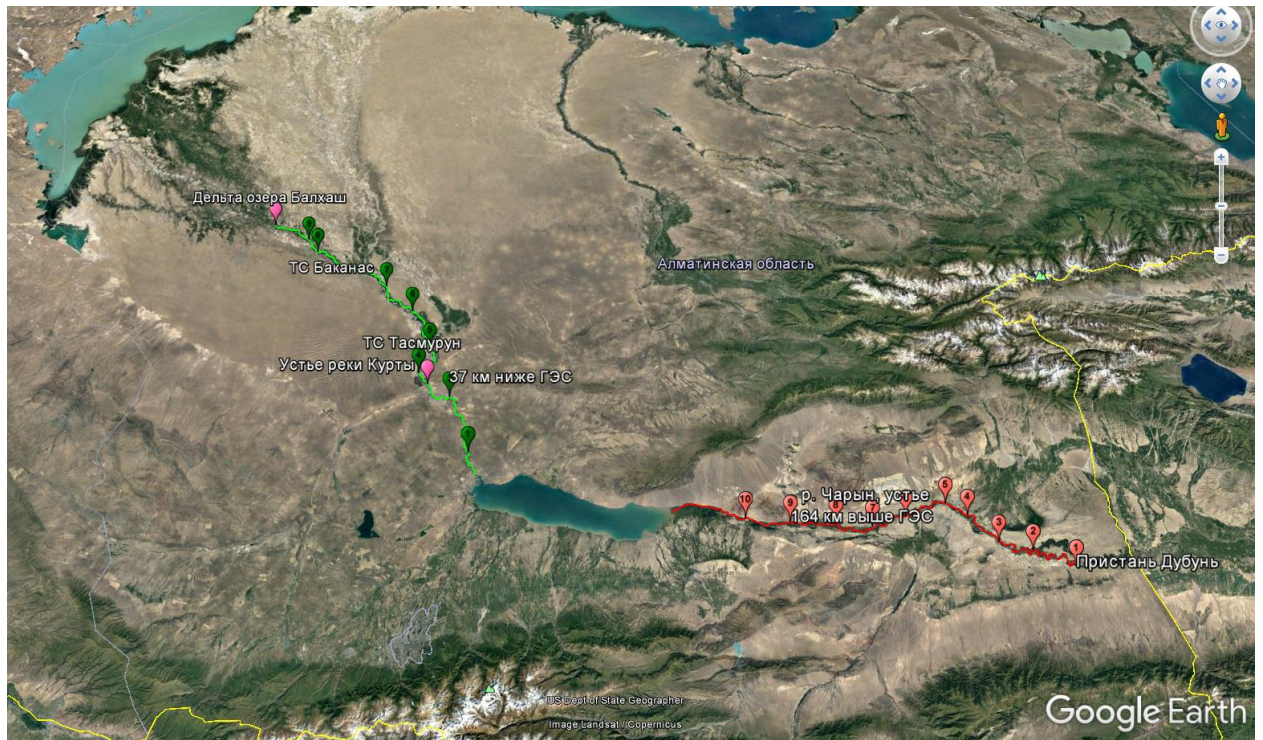
Рисунок 2.7 – Расположение и нумерация точек, где были получены данные поперечного сечения (зеленым обозначены точки расположенные ниже ГЭС, красным – точки, расположенные выше ГЭС)
