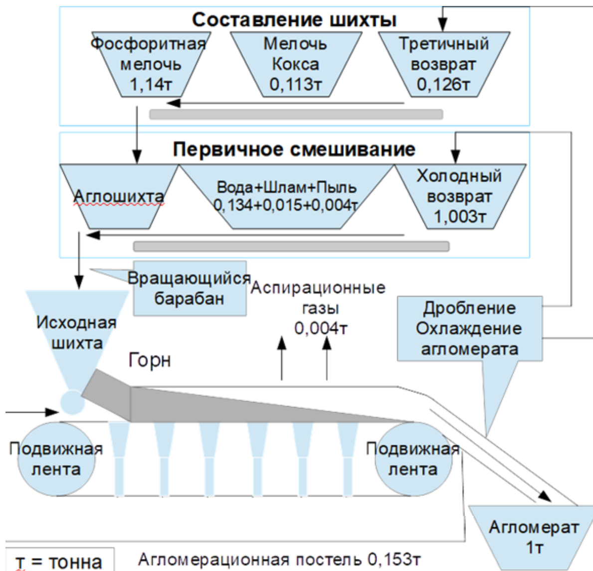
Рисунок 1.1 – Технологический процесс агломерации фосфоритовых руд
