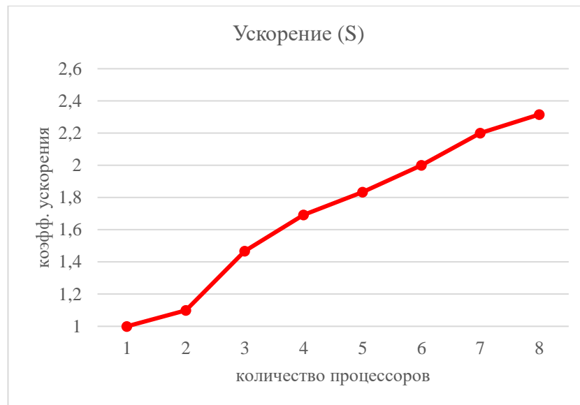
Рисунок 2.2 – График зависимости ускорения от количества процессоров
