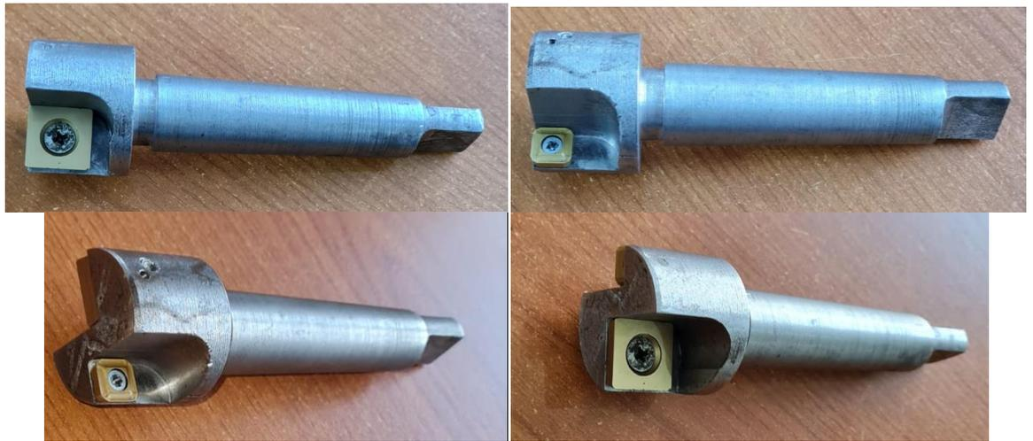
Рисунок 2.40 – Опытные образцы СРГ с твердосплавными пластинами разной ширины
