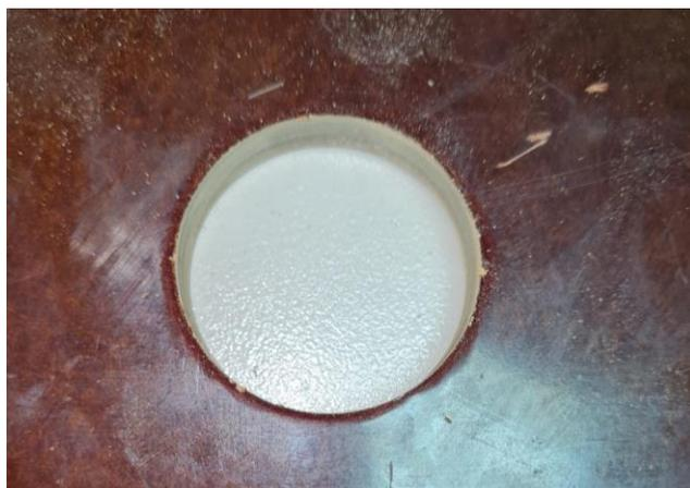
Рисунок 3.22 – Отверстие в листе из гетинакса полученное при обработке СРГ с твердосплавными пластинами разной ширины с установкой пластины меньшей ширины на периферии
