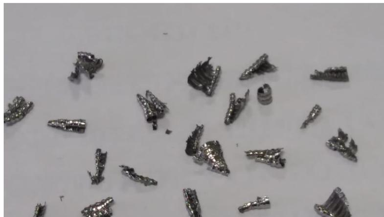
Рисунок 3.7 – Стружка образуемая при обработке заготовки из стали 45
