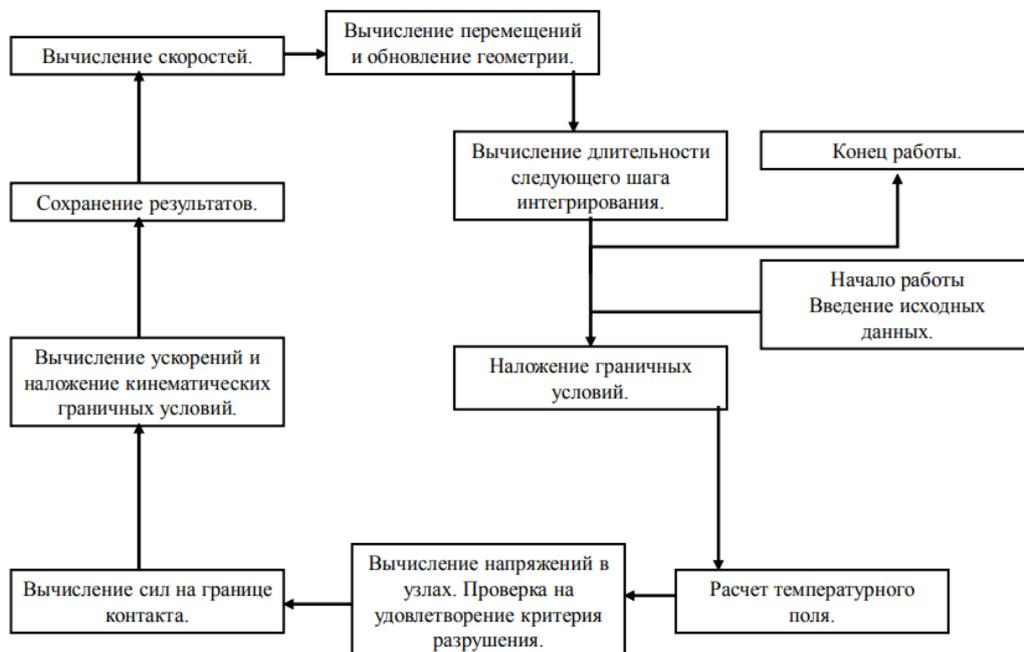
Рисунок 2.18 – Схема моделирования процесса резания [104]
