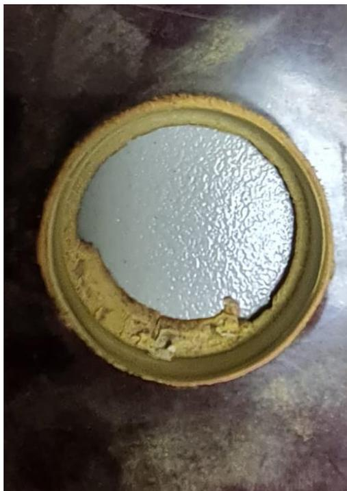
Рисунок 3.20 – Отверстие в листе из гетаникса полученное при обработке спиральным сверлом
