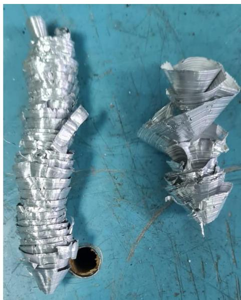
Рисунок 3.5 – Стружка, образуемая при подаче 0,25 мм/об при обработке заготовки из алюминиевого сплава
