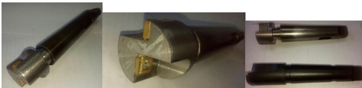
Рисунок 2.39 – Опытные образцы СРГ с твёрдосплавными пластинами одинаковой ширины
