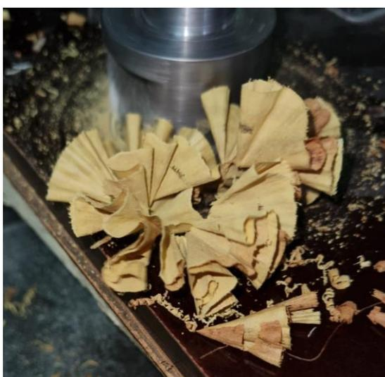
Рисунок 3.23 – Процесс отвода стружки при обработке СРГ твердосплавными пластинами разной ширины с установкой пластины меньшей ширины на периферии
