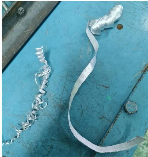
Рисунок 3.6 – Стружка, образуемая при  $n = 800$  об/мин при обработке заготовки из алюминиевого сплава
