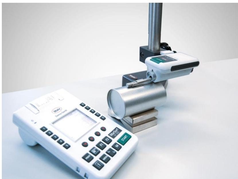
Рисунок 3.3 – Мобильный прибор MarSurf M 300
