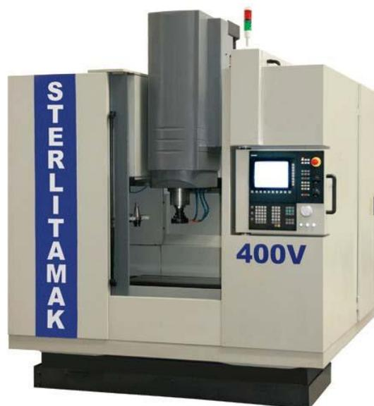
Рисунок 3.1 – Сверлильно-фрезерно-расточной станок 400V с ЧПУ
