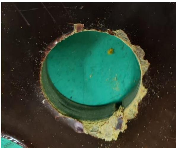
Рисунок 3.21 – Отверстие в листе из гетаникса полученное при обработке СРГ с равными пластинами
