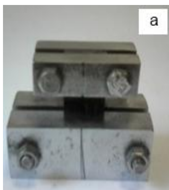
а - беткі көрінісі; б – бүйір көрінісі Сурет 19 – Пластиналарды сығуға арналған құрылғы
