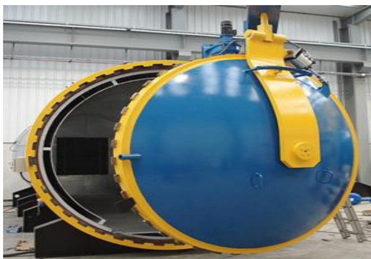
Сурет 6 – Көмірпластикті автоклавпен қалыптау [27]
