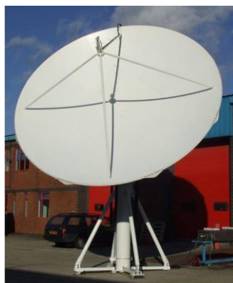
Сурет 3.3 – Қабылдау-тарату жер антеннасы
