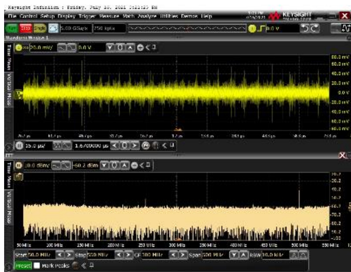
Сурет 2.10 – 500 МГц өткізу жолағындағы және 5 ГТандалым/с ажыратымдылығы кезіндегі шуыл сигналының осциллограммасы мен спектрограммасы
