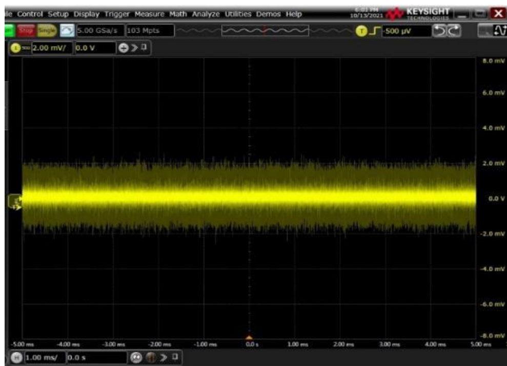
Сурет 2.6 – 1200 МГц-тен 1800 МГц-ке дейінгі жиіліктер өрісіндегі бүркемелейтін шуыл бөгеуілдерінің осциллограммасы
