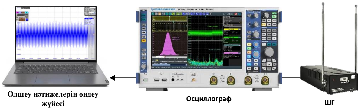
Сурет 2.1 – Цифрлық есте сақтау қабілеті бар осциллографты қолданатын өлшеу стендінің сұлбасы
