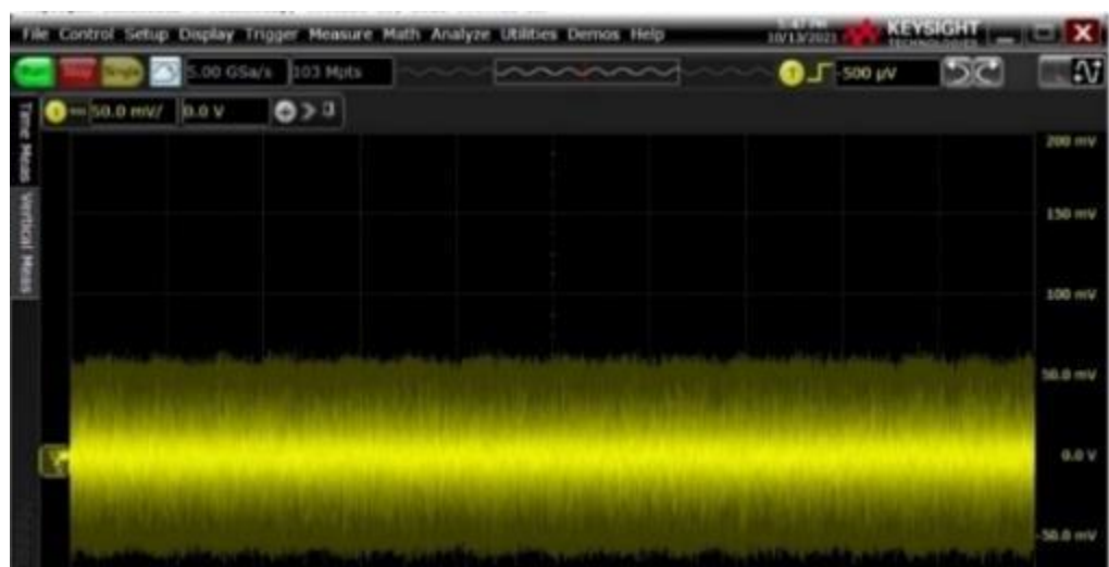
Сурет 2.4 – 600 МГц-ке дейінгі жиіліктер өрісіндегі бүркемелейтін шуыл бөгеуілдерінің осциллограммасы
