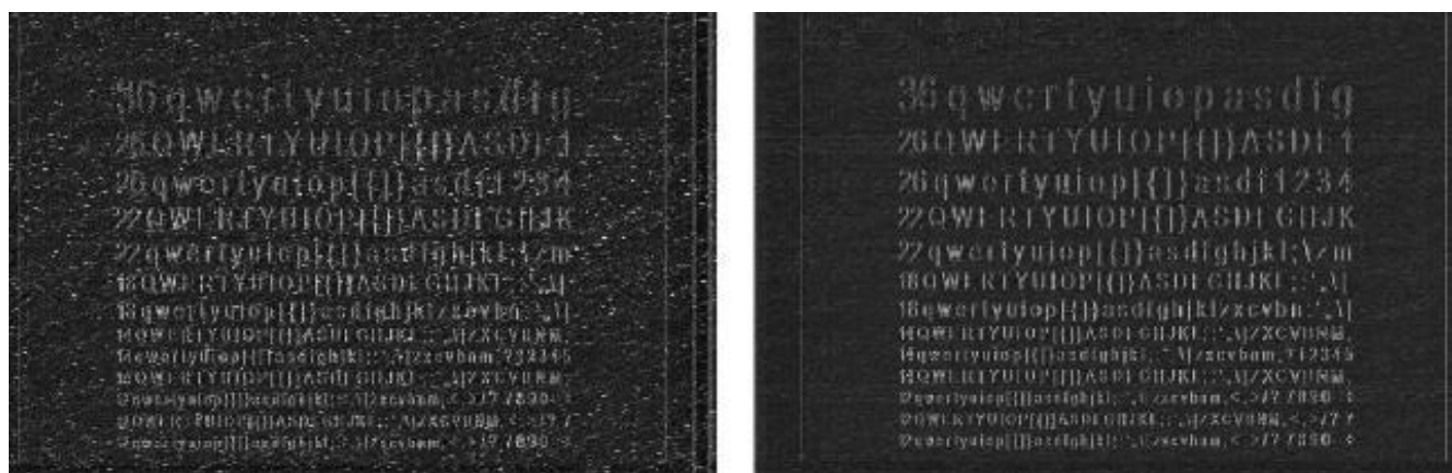
Сурет 1.5 – Өткізу жолағы 50 МГц болатын қабылдау құрылғысының бейне интерфейсінің 286 МГц жиіліктегі қалпына келтірілген ЖЭМС кескіндері
