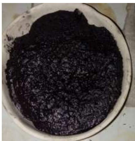
Рисунок 20 – Спек исходной руды с сульфатом аммония в присутствии концентрированной серной кислоты, полученный в оптимальных условиях
