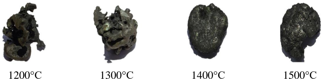
Сурет 3.10 – Әртүрлі температурада ұстаудан кейін алынған брикет сынамаларының үлгілері
