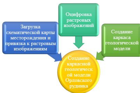
Рисунок 4.3 - Этапы создания каркасной литологической модели
