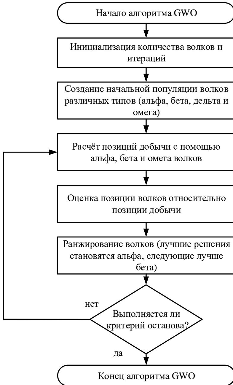
Рисунок 3.5 – Блок-схема реализации алгоритма оптимизации серого волка
