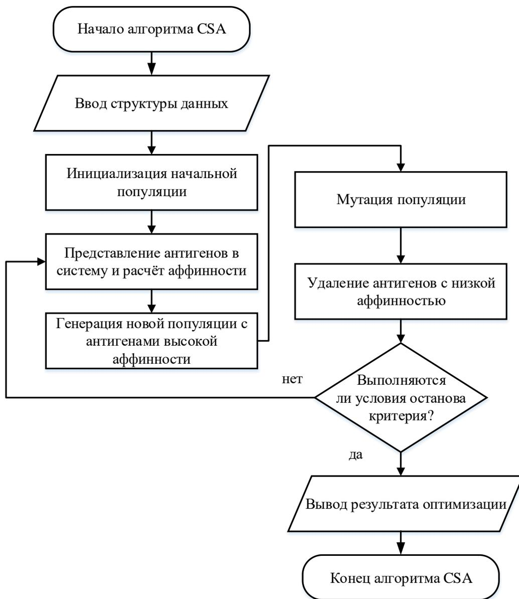
Рисунок 3.7 – Блок-схема реализации алгоритма CSA
