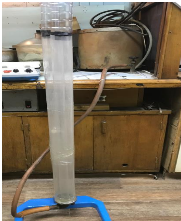
Рисунок 49 – Установка для грануляции плава нитрата кальция
