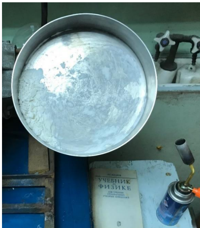
Рисунок 52 – Получение чешуйчатого нитрата кальция на грануляторе
