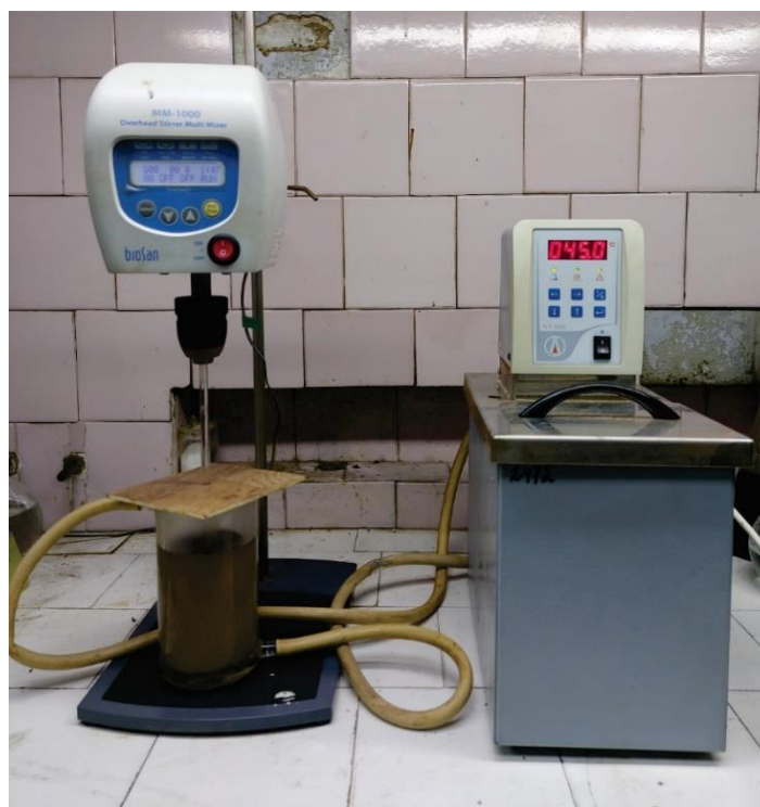
Рисунок 17 – Проведение опытов по изучению кинетики выщелачивания шлама с определением зависимости от температуры
