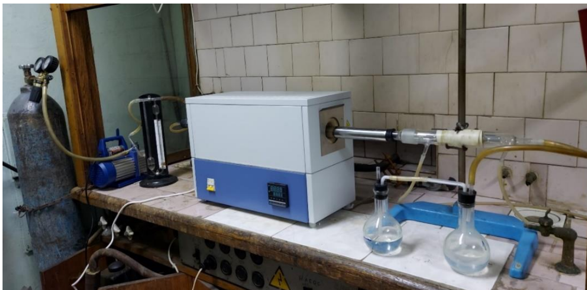
Рисунок 54 – Лабораторная установка по возгонке фторидов кремния и титана
