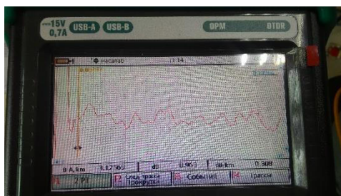
Рисунок 4.26 - ОВ длиной 3,134 км, мертвая зона составляет - 0,00797, затухание на км – 0,308
