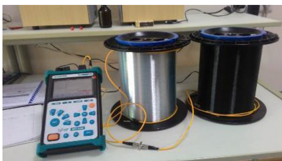
Рисунок 4.24 - Измерение двух соединенных катушек с помощью розетки
