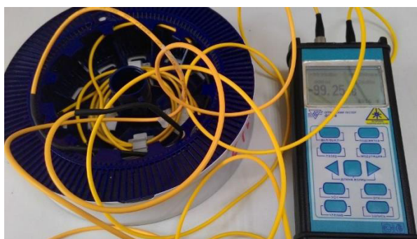
Рисунок 4.23 - Измерения с тестером OT-2-8
