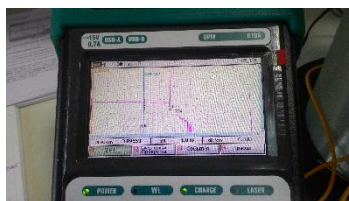
Рисунок 4.27 - ОВ длиной 4,735 км, мертвая зона составляет - 0,0856, затухание на км – 0,338 дБ/км.
