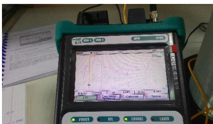
Рисунок 4.25 - ОВ длиной 3,182 км, мертвая зона составляет - 0,00802, затухание на км – 0,343 дБ/км
