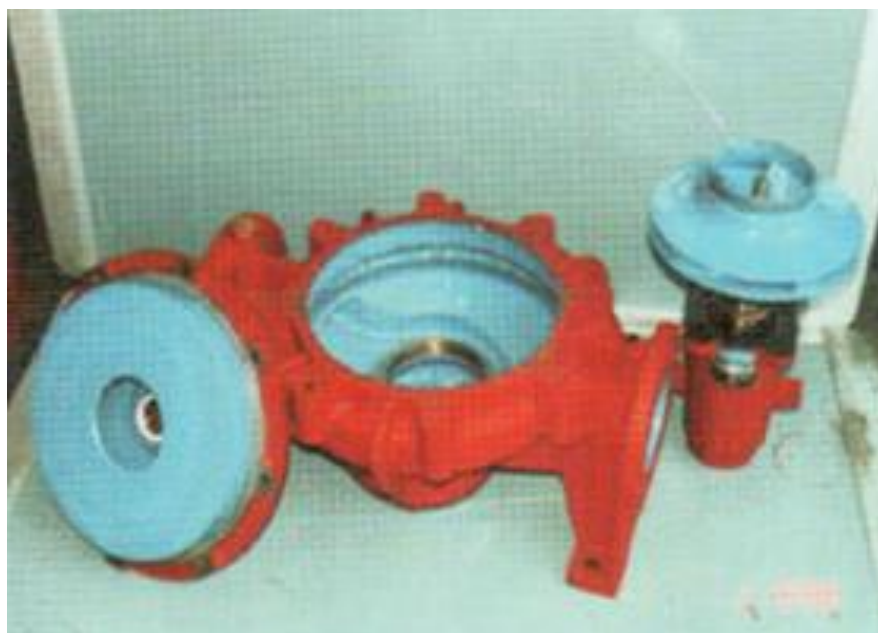
Сурет 1 – Консольді сорғының шиыршықты корпусы
