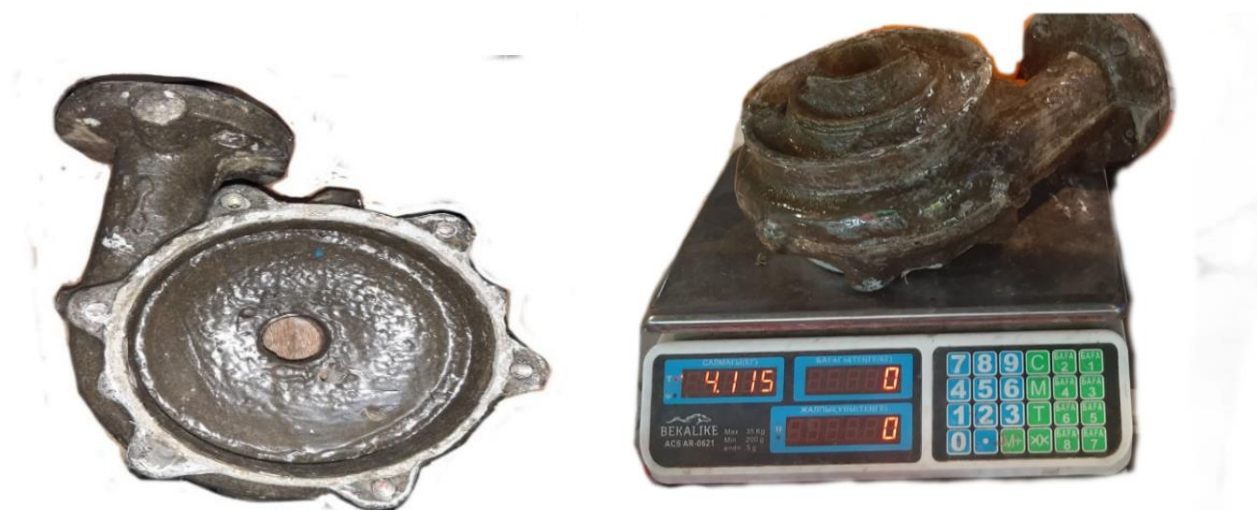
Сурет 51 – Фибробетоннан алынған ортадан тепкіш сорғы корпусы және өлшеу процесі
