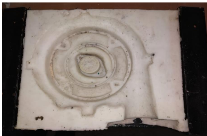
Сурет 33 – Шиыршықтың ішкі бетін құю пішіндерінің жартылары
