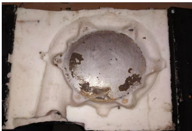
Сурет 32 – Шиыршықтың сыртқы бетін құю пішіні
