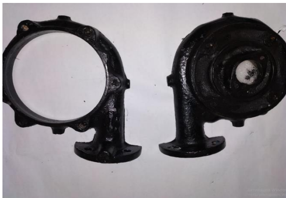
Сурет 30 – Екі бөлікке бөлінген шиыршық корпусы
