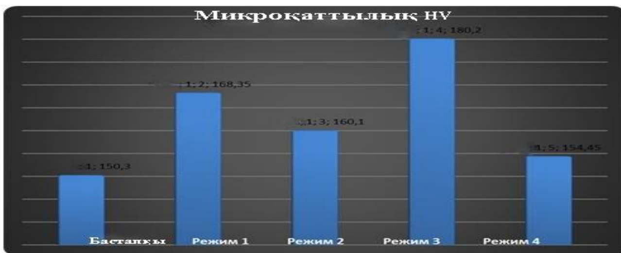
47- Сурет. Әртүрлі режимдерде Д16 үлгісінің микроқаттылығының диаграммасы
