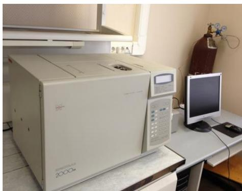
Рисунок 15 – Аналитический блок для контроля состава газовой фазы
