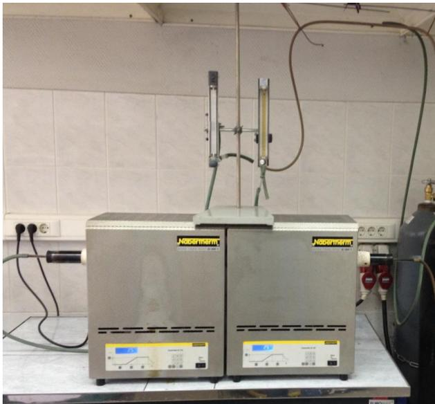
Рисунок 14 – Общий вид установки для проведения опытов по обжигу золы совместно с хлоридом кальция
