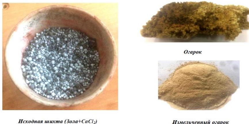
Рисунок 16 – Общий вид исходной шихты и полученного огарка
