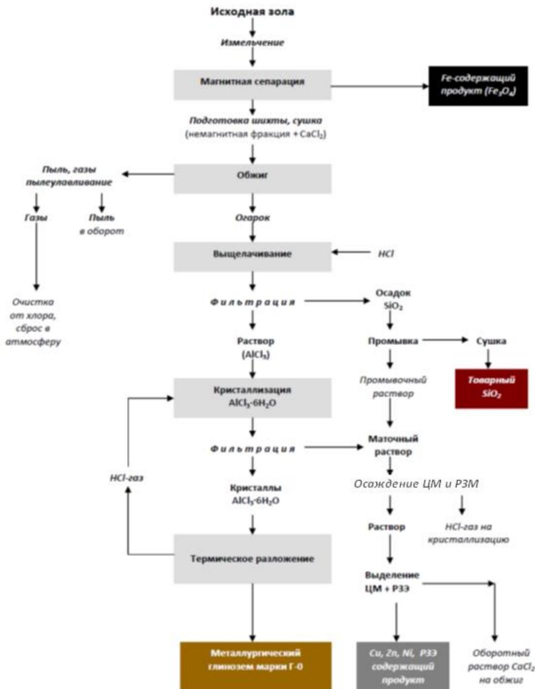
Рисунок 47 – Принципиальная технологическая схема комплексной переработки золошлаковых отходов ТЭЦ с получением товарных продуктов
