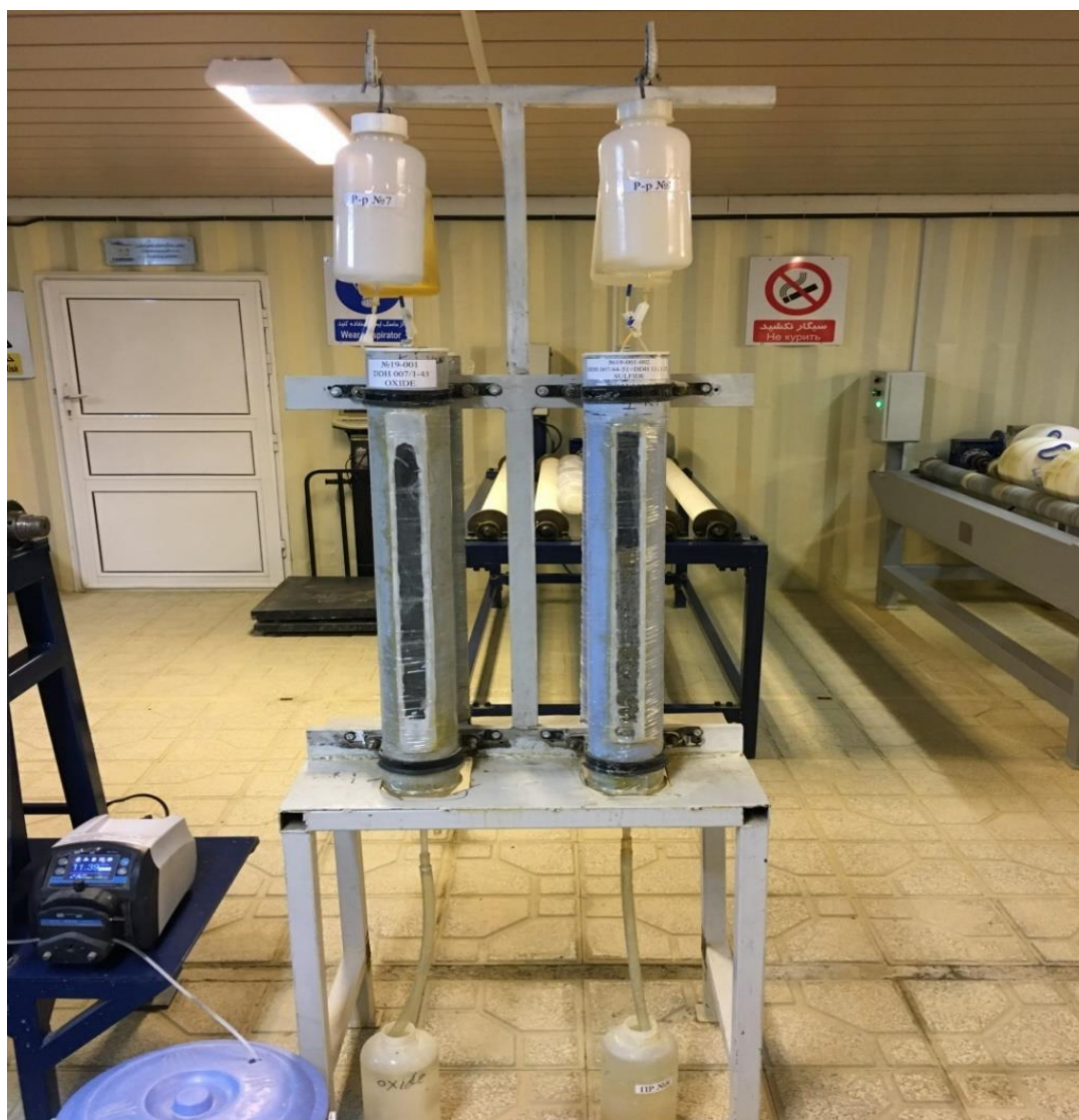
Рисунок 32 – Лабораторная установка для проведения колонных тестов
