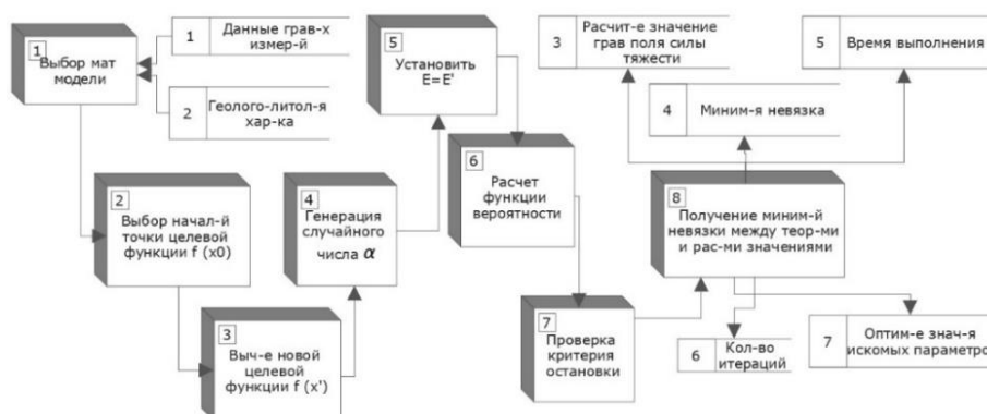
Рисунок 3.4 – DFD-модель бизнес-процесса «Решение прямой задачи гравиметрии методом имитации отжига»
