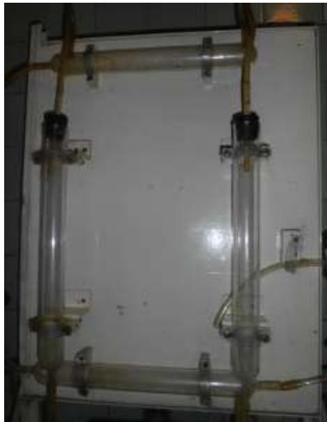
Рисунок 19 – Испытательный стенд на коррозию
