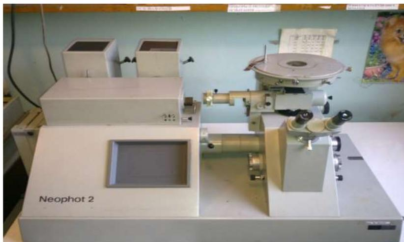
Рисунок 15 – Оптический микроскоп Neophot-2
