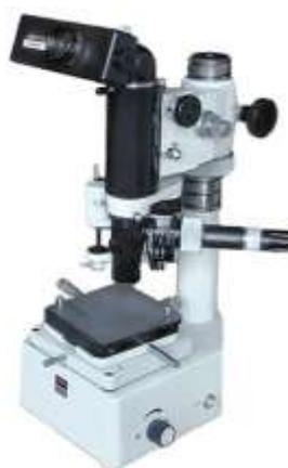
Рисунок 21 - Микротвердомер ПМТ-3
