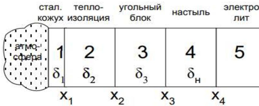
Рисунок 11 - Схема бортовой стенки электролитической ванны и настывли [92 с. 60]
