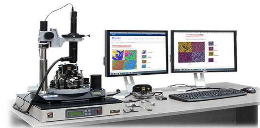
Рисунок 17 - Атомно-силовой микроскоп «Integra Terna»
