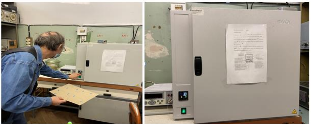
Сурет 3.6 – SNOL 38/350 әмбебап кептіру шкафындағы Брэгг торына температуралық әсер ету процесі
