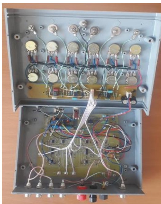
Сурет 3.10 – ФицХью-Нагумо нейрондарынан құралған жүйені имитациялауға арналған аналогты электронды қондырғының ішкі көрінісі
