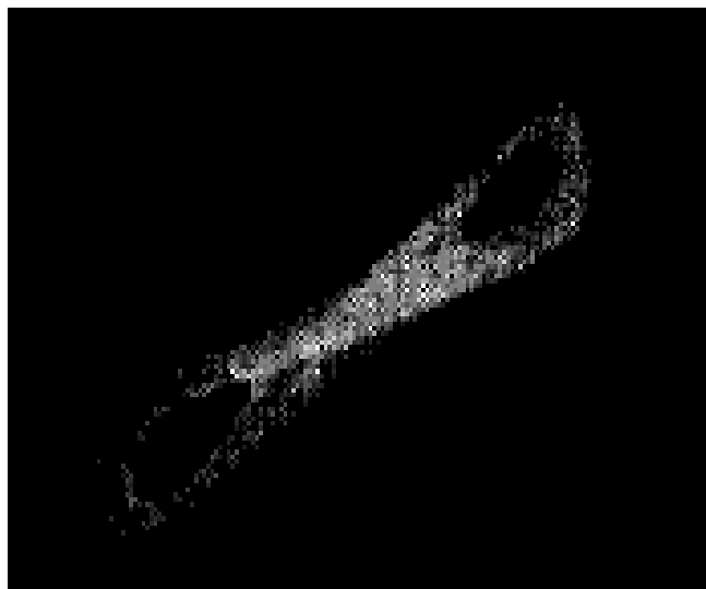
Сурет 1.11 – Осциллографтағы үш элементті автономды CNN-нің хаотикалық траекториялары
