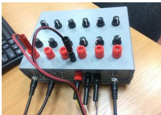
Сурет 3.9 – ФицХью-Нагумо нейрондарынан құралған жүйенің аналогты электронды қондырғысының сыртқы көрінісі
