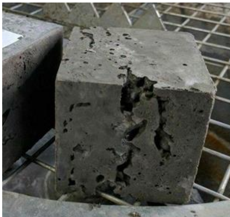
7 Сурет - Үлгілер-630 мм конустық диффузиясы бар өздігінен нығыздалған бетон текшелері
