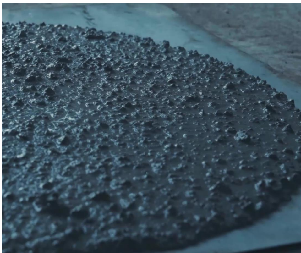
15 Сурет - Өздігінен нығыздалатын бетон қоспасындағы толтырғыштың дұрыс таралуы
