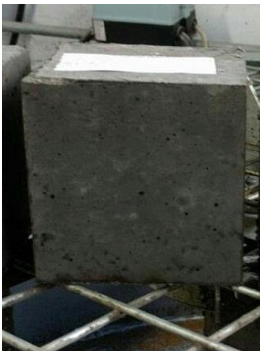
8 Сурет. 690 мм конустық жайылымы бар өздігінен нығыздалатын бетон текшелерінің үлгілері
