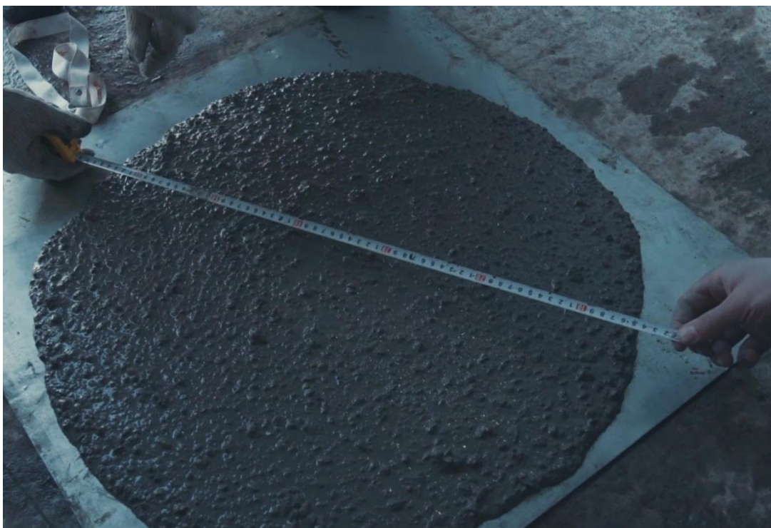
9 Сурет - Өздігінен нығыздалатын бетон конусының жайылымын өлшеу
