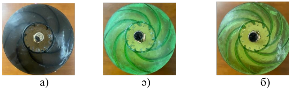
а) 6 қалақшалы дөңгелек ә) 7 қалақшалы дөңгелек б) 8 қалақшалы дөңгелек
