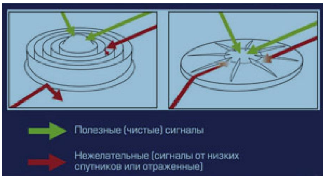
Рисунок 5.2 – Схема влияния эффекта многопутности на антенны типа Choke Ring (слева) и Zephyr Geodetic (справа).
