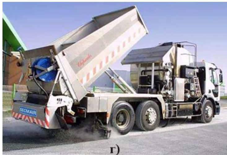
Сурет 2.3-БҚТТ негізінде битум-қиыршық тас таратуды автоматты басқару жүйесі [18]
