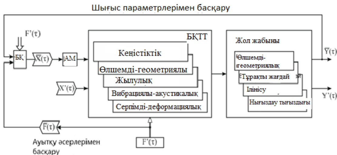
Сурет 2.1-Автоматты басқару нысаны ретінде битум-қиыршық тас таратқыш
