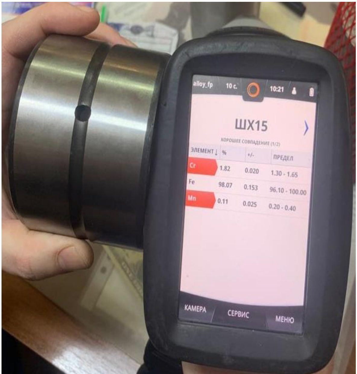
Сурет 3.5 - 7J-9346 бұрылу гидроцилиндрі соташығының сырғалық тесігінің төлкесі
