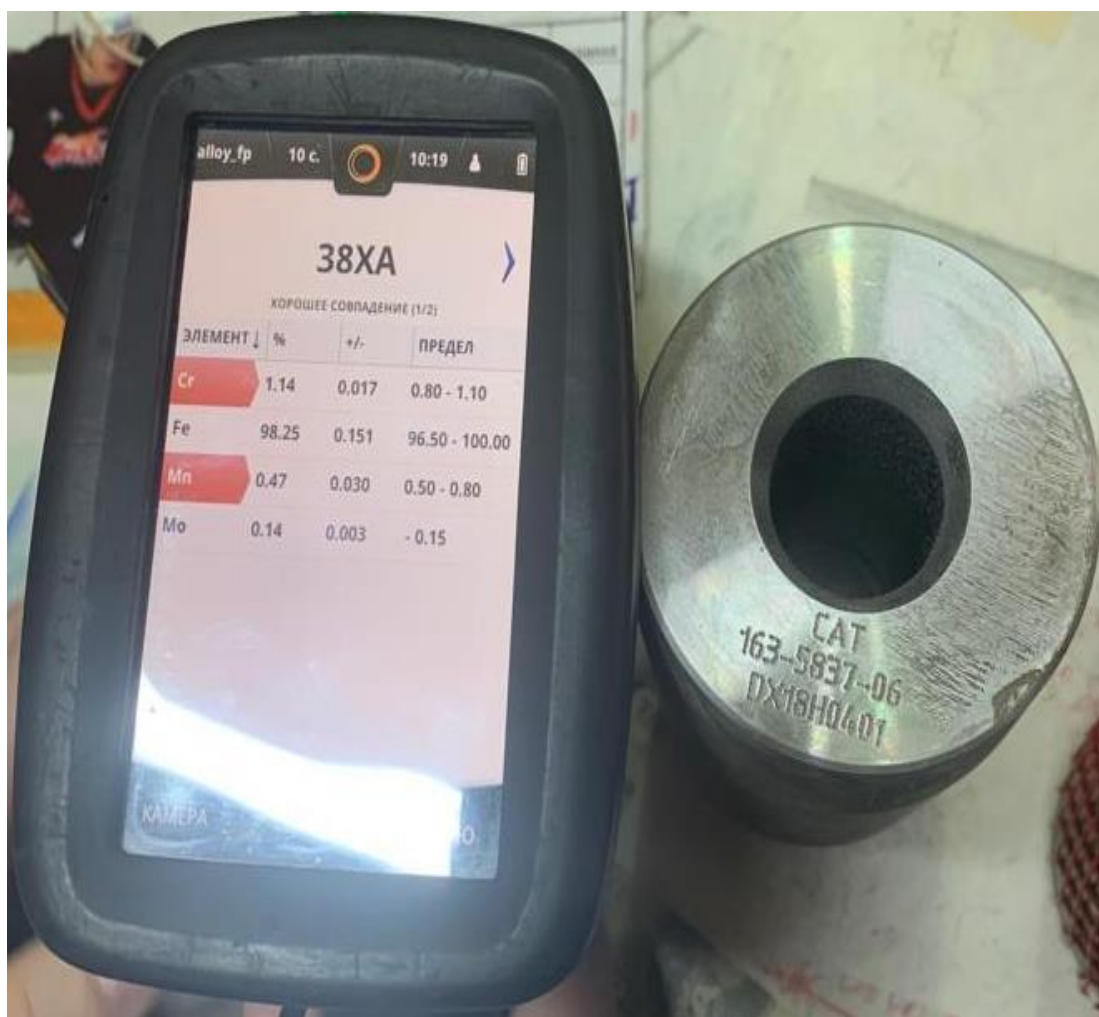
Сурет 3.4 - CAT 163-5837-06 DX18H0401 бұрылу гидроцилиндрінің соташықты бекіту топсасының саусағы
