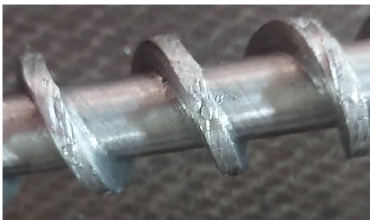
Сурет 5.8 – Шнектің зақымдану фотосуретті
