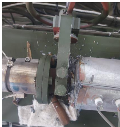
Сурет 6 – Жаппалы клапаннан материалдың ағу кезеңі
