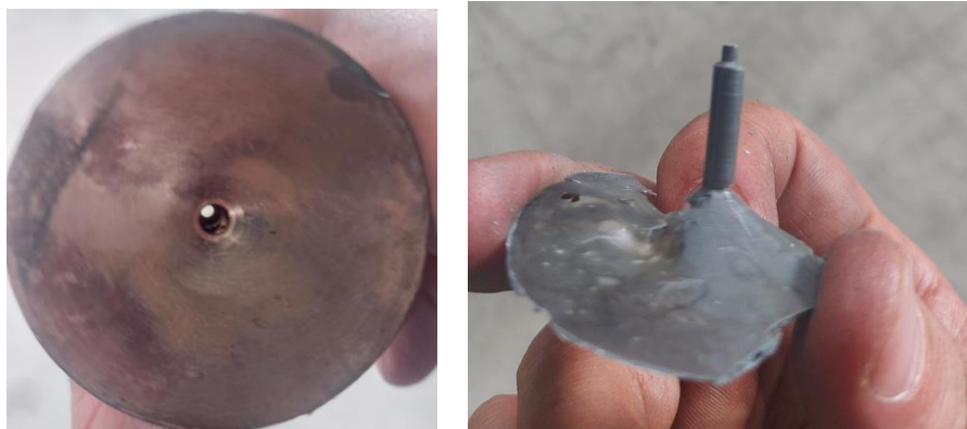
Сурет 6.1 – Матрица және оның ішіндегі шикізат қалдығы
