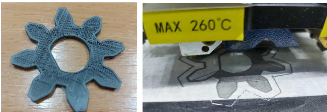
Сурет 9.2 - 3D принтерде басып шығару кезіндегі филаменттің дұрыс берілмеуі
