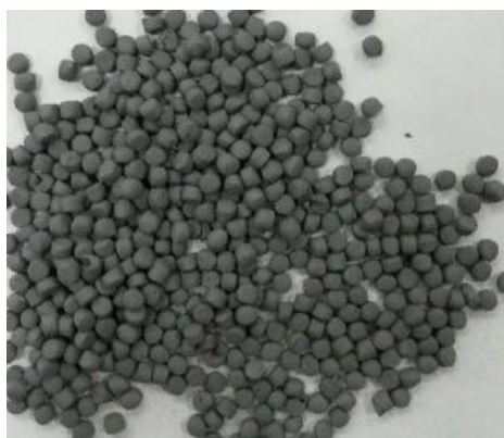
Сурет 1 – Металл-полмерлі композиттік материалдың түйіршіктері
